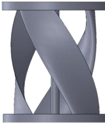
Figura 14. Vista frontal de la turbina de río.
