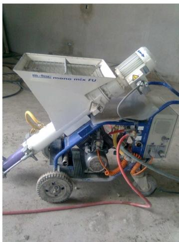
*Imagen 4.1.1 "Máquina lanzadora de mortero"*
