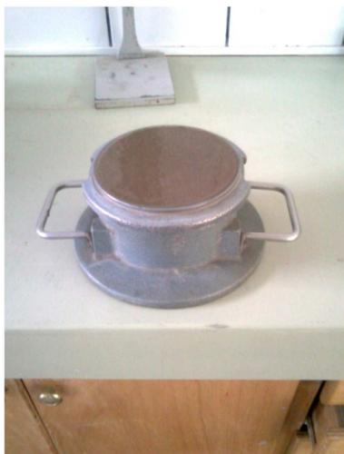
Imagen3.1.2a “Olla de medición de aire sin tapa”
