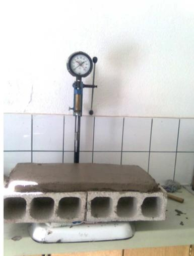
Imagen 3.2.2”Resistencia a la penetración. Tiempos de fraguado del mortero aplicado en bloque.”
