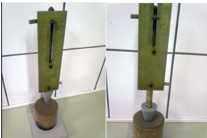
*Imagen 3.1.1 "Medición de la consistencia del mortero en estado fresco"*
