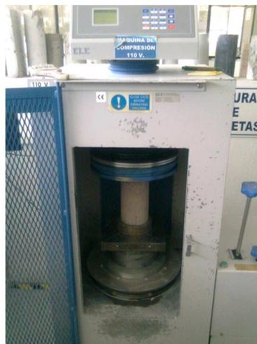
*Imagen3.2.1 “Ensayo a la compresión del cilindro de mortero”*
