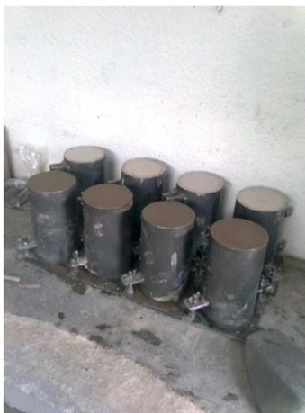
*Imagen3.1.5”Cilindros de mortero para medición de resistencias”*
