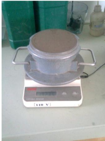
*Imagen 3.1.3 "Medición de la masa del mortero en la olla para cálculo de peso unitario"*
