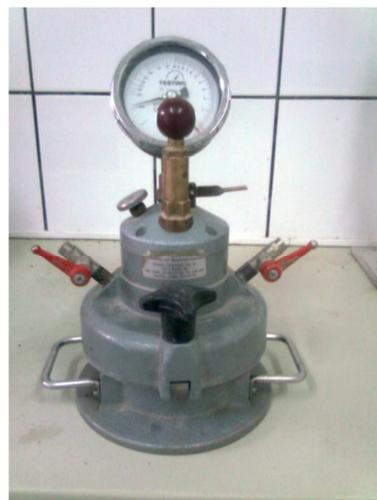
Imagen 3.1.2b”Olla de medición de aire con tapa”
