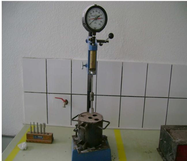
*Imagen3.1.6"Ensayo tiempos de fraguado, penetrómetro ACME"*
