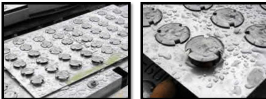
**Figura 2-2:** Placa de válvula (40)
