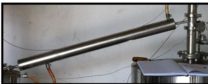
**Figura 4-19.** Intercambiador de calor inferior
