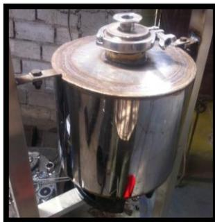
**Figura 4-23.** Condensador superior en soporte
