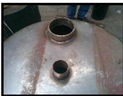
**Figura 4-1.** Adaptaciones en la sección superior y lateral del reactor de craqueo.
