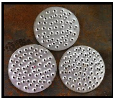
**Figura 4-14.** Platos de columna de destilación
