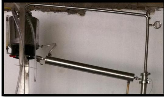
**Figura 4-16.** Conexión superior de la columna a los condensadores
