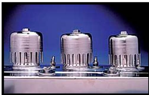
**Figura 2-3:** Placa de burbujeo (39)
