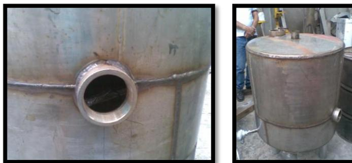
**Figura 4-3.** a) Adaptación lateral rosca. b) Reactor de craqueo sin recubrimiento
