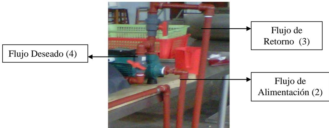
**Figura 5.2 Equipo utilizado para la pasteurización con luz UV**
