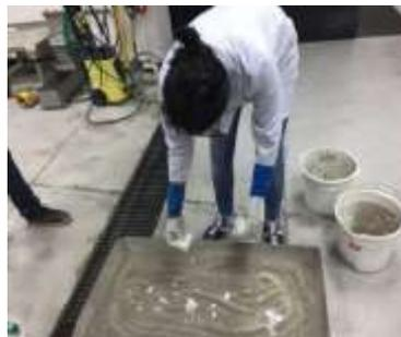
**Figura 65: Mezcla de cemento con fibras**
