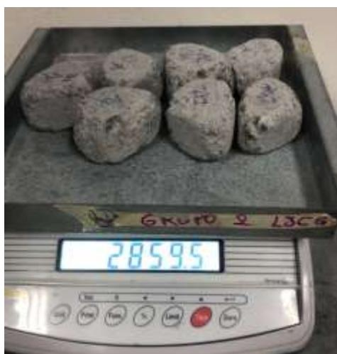
***Figura 21: Muestra de hormigón después del ensayo por abrasión***
