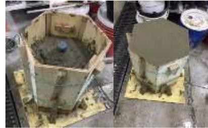
**Figura 69: Cápsula en etapa de fraguado de hormigón.**
