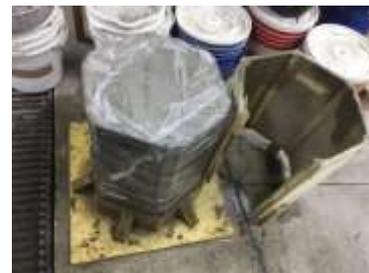
**Figura 70: Desencofrado de la capsula**
