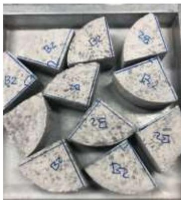
**Figura 20: Muestra para elaborar ensayo por abrasión de hormigón**
