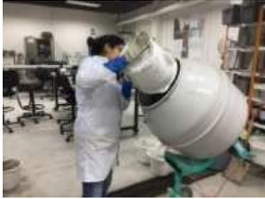
**Figura 66: Colocar materiales en la concretetera**
