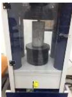
*Figura 17: Ensayo De Resistencia a la Compresión*
