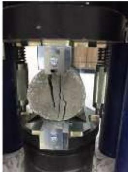
*Figura 18: Ensayo de Resistencia a la Tracción Indirecta*
