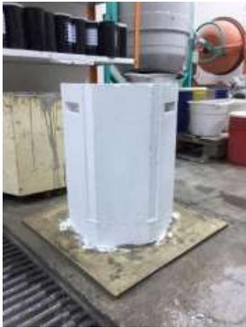
*Figura 72: Cápsula con la capa final de pintura impermeabilizante*
