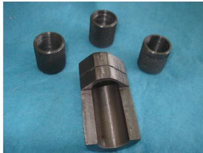
**Fig. 8** Dispositivo diseñado para la elaboración de los cilindros de acrílico y para el corte a una distancia de 5 mm.
