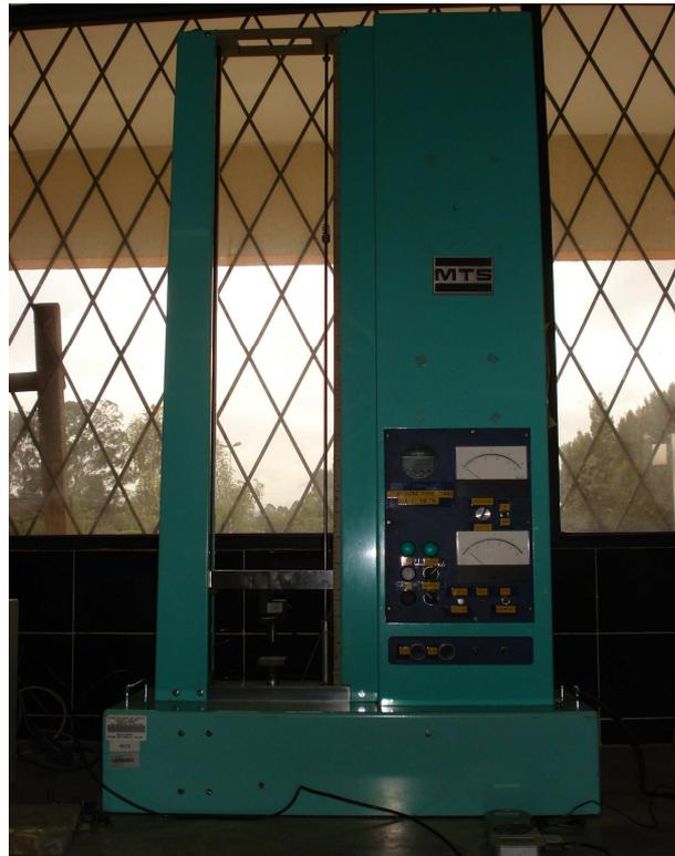
**Fig 12.** Máquina para pruebas de tensión y presión ( JJ machine type T5002)
