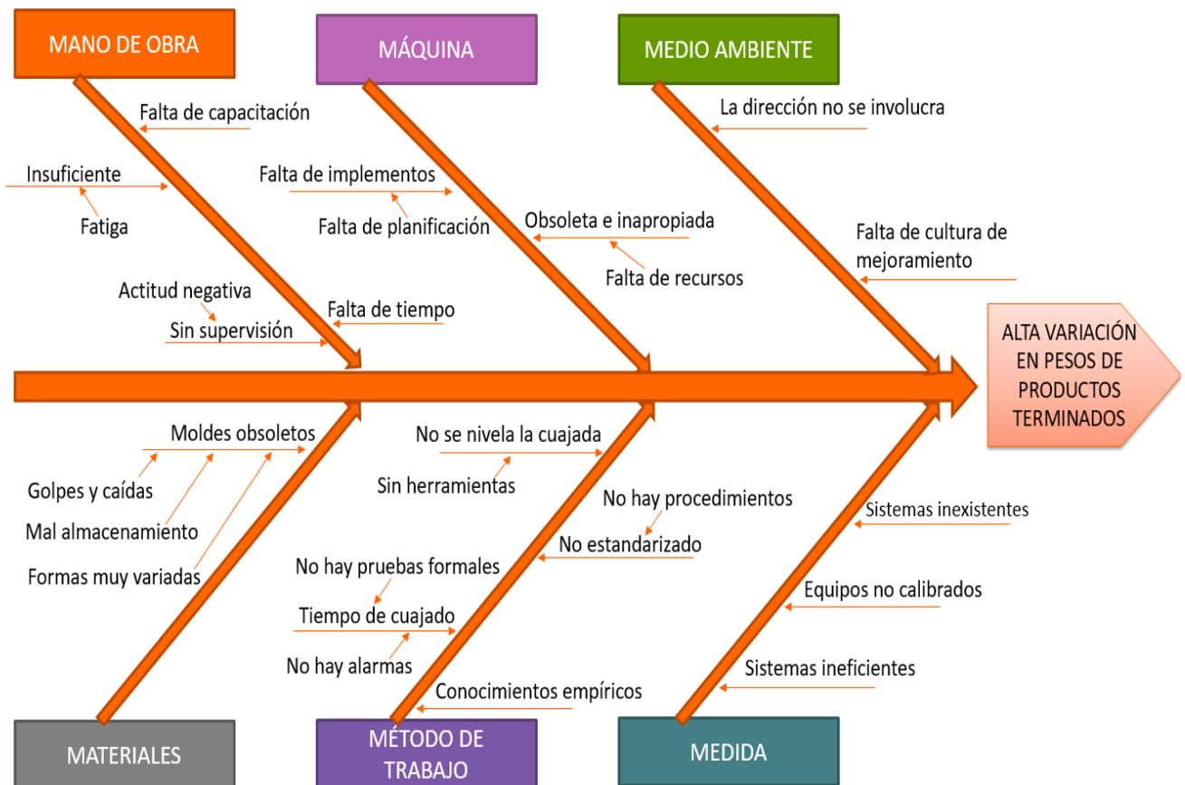
*Ilustración 60: Diagrama Causa Efecto de la Excesiva variación en el peso de los productos terminados*
