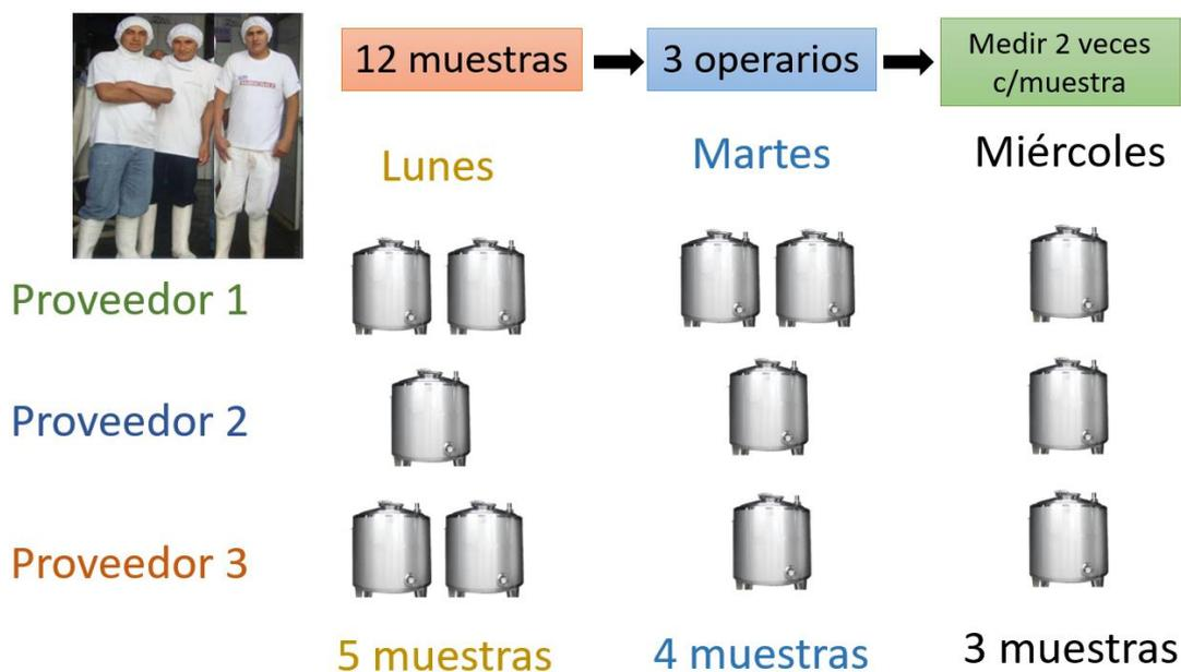
Ilustración 39: Muestra para el primer análisis del sistema de medición
