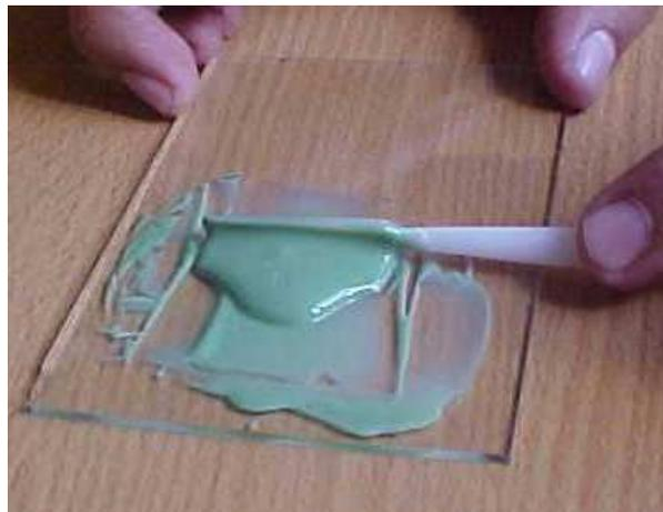
Figura 21. Mezcla manual de silicona de adición de consistencia liviana.
