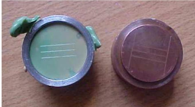
Figura 24. Muestra polimerizada y separada del patrón maestro metálico.
