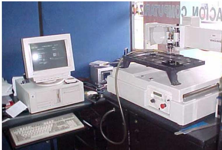
Figura 6. Máquina para grabado en metal con precisión computarizada.
