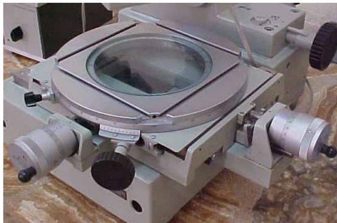
Figura 26. Mesa goniométrica 0-360° del “Gran Microscopio de Herramientas”.
