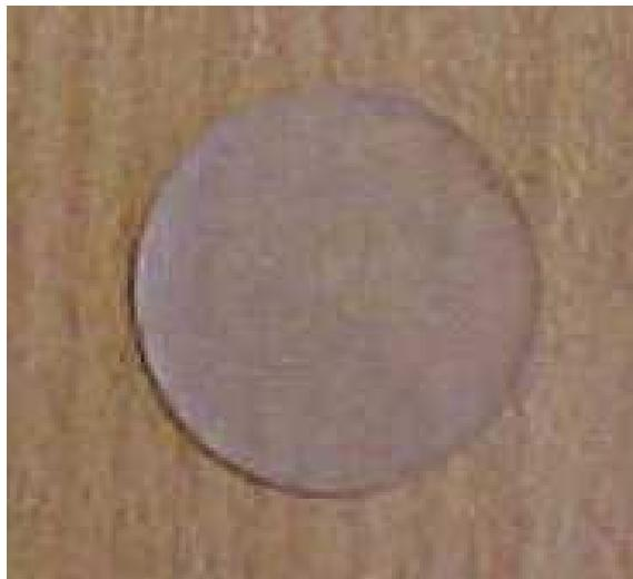
Figura 12. Espaciador de lámina de acrílico de 2 mm de espesor.
