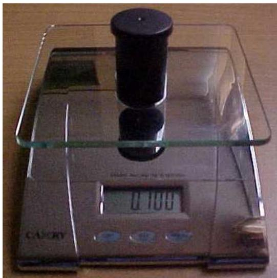
Figura 22. Peso de 100 gramos que simuló el sostenimiento de la cubeta en boca.
