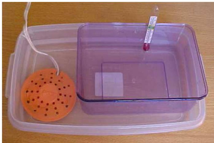
Figura 18. Recipientes con agua para mantener la temperatura, calentador eléctrico en recipiente inferior y termómetro en recipiente superior.
