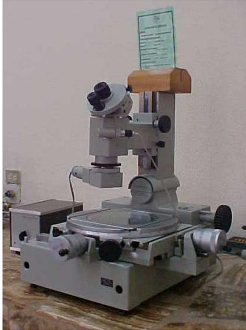
Figura 25. “Gran Microscopio de Herramientas”, marca Carl Zeiss Jena.
