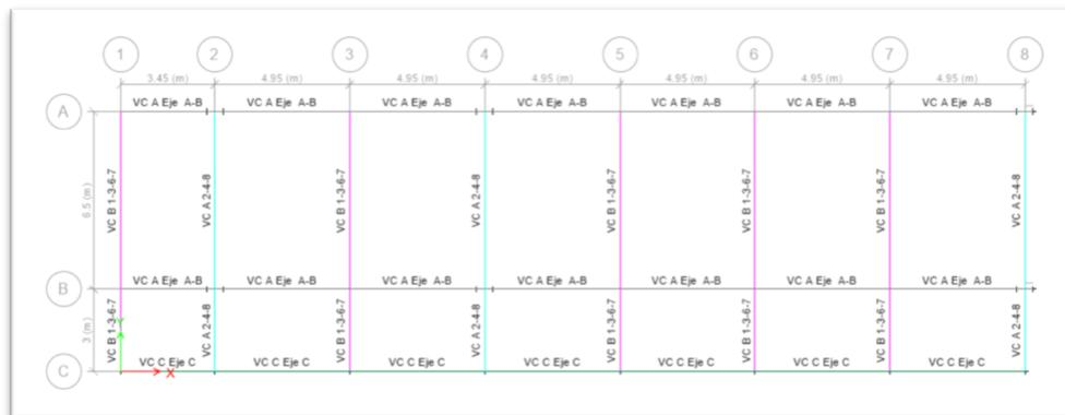
Figura 12. Vista en planta vigas de cimentación.
