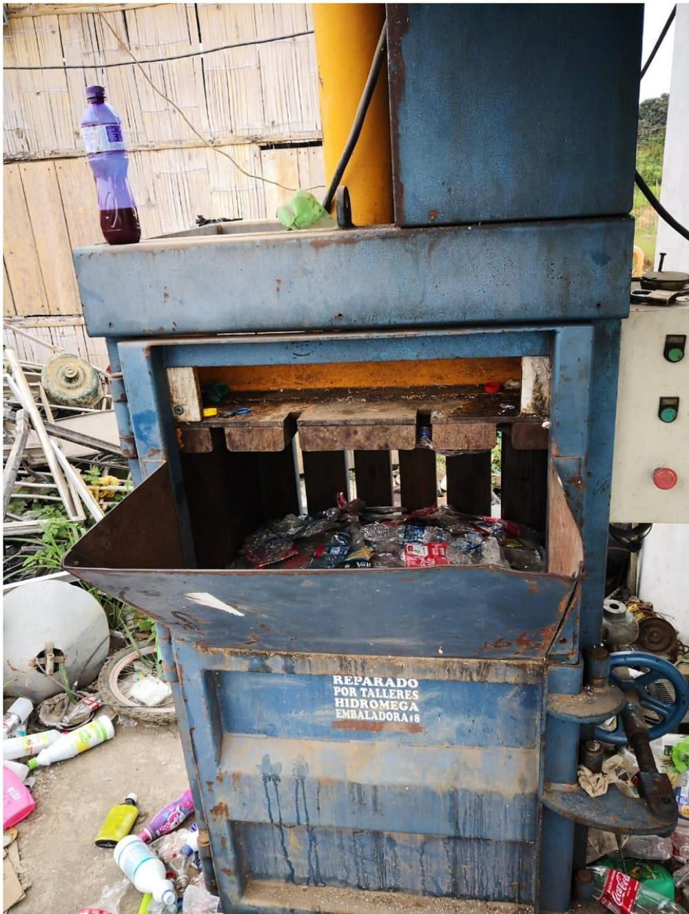
Figura b: Compactadora de plástico
