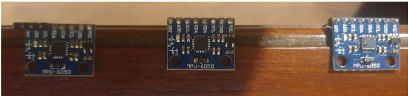
Figura 9: Ubicación de los sensores de prueba MPU 6050
