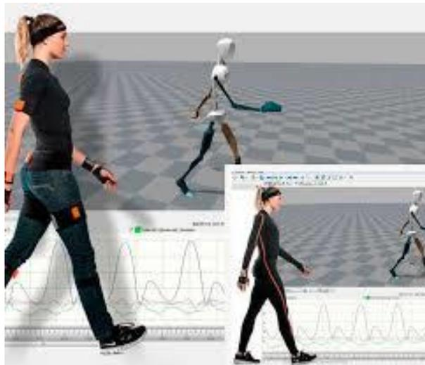
Figura 2: Sistema de captura de movimiento inercial. (Xsens, 2018)
