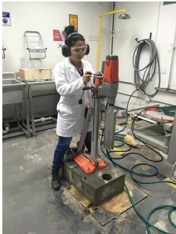
Figura 6. Mecanismo de extracción de núcleos de hormigón.
