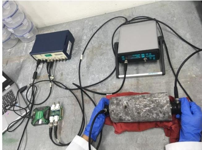
Figura 10. Esquema de conexión para medir velocidad de corte.
