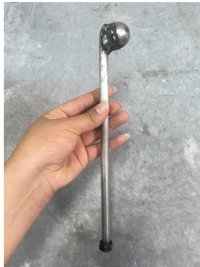
Figura 13. Martillo de acero con esfera soldada para dar golpes.
