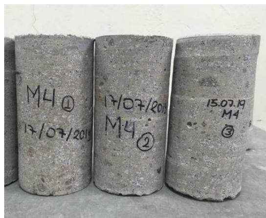
Figura 7. Núcleos de hormigón obtenidos de la perforación
