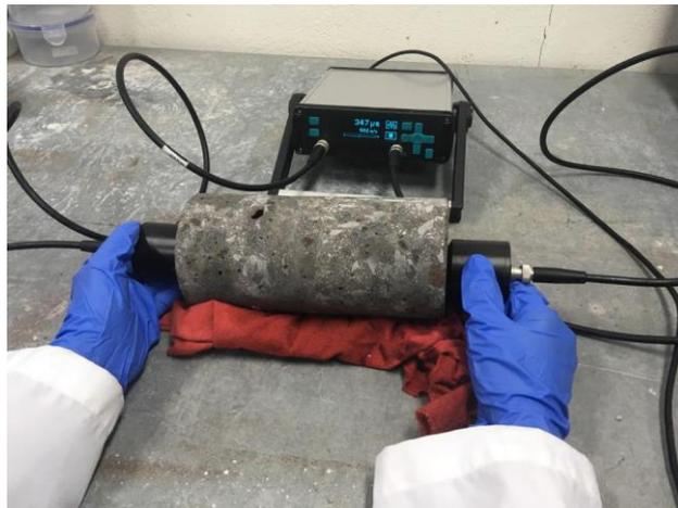
Figura 9. Esquema de conexión para medir velocidad de pulso.
