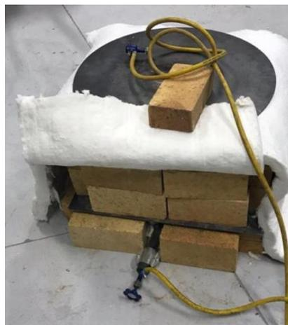
Figura 5. Mecanismo de exposición a alta temperatura de losetas (Moreno, 2018).
