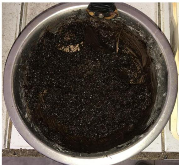
Figura 11: Ensayo de mezcla agregando fibras recortadas
