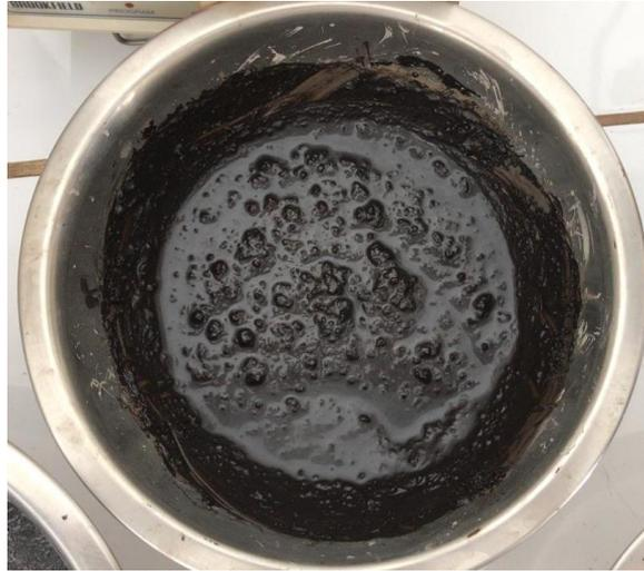
*Figura 9: Ensayo de mezcla agregando fibras recortadas*
