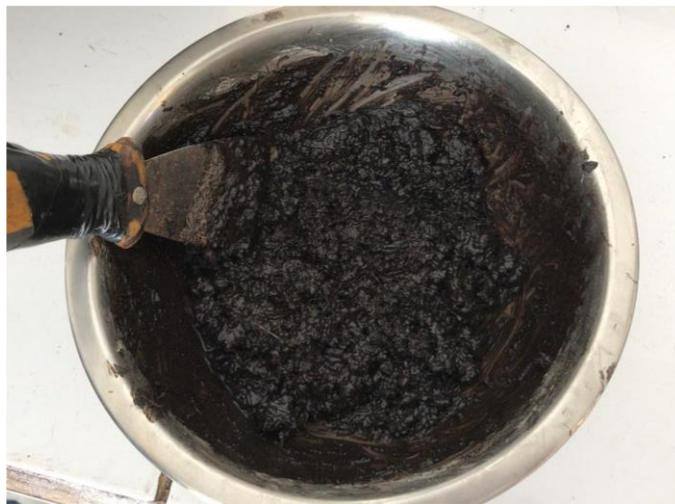
Figura 10: Ensayo de mezcla agregando cemento y fibras recortadas
