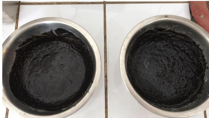
*Figura 6: Comparación de ensayos con diferente porcentaje de agua. Izquierda 13% y derecha 12%*
