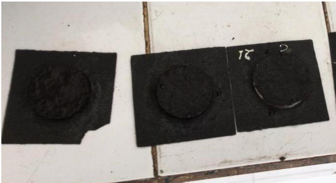
*Anexo A4: Pastillas para el ensayo de cohesión*
