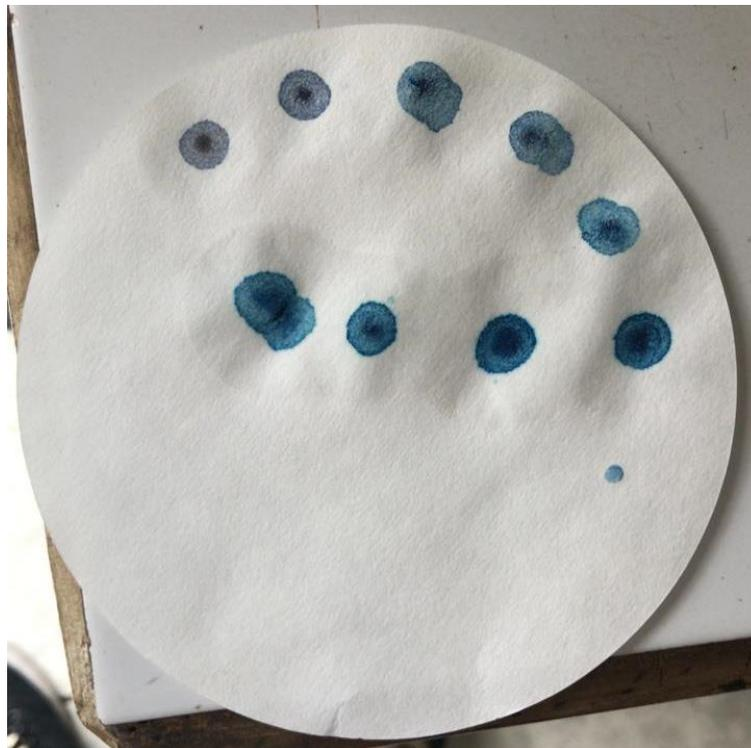
*Anexo A2: Ensayo de sanidad de agregado utilizando azul de metileno*
