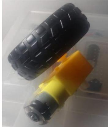
*Figura # 10. Par Motores-llanta*
