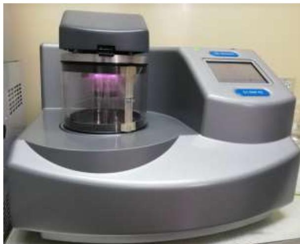
**Figura 15.** Evaporizador de oro
