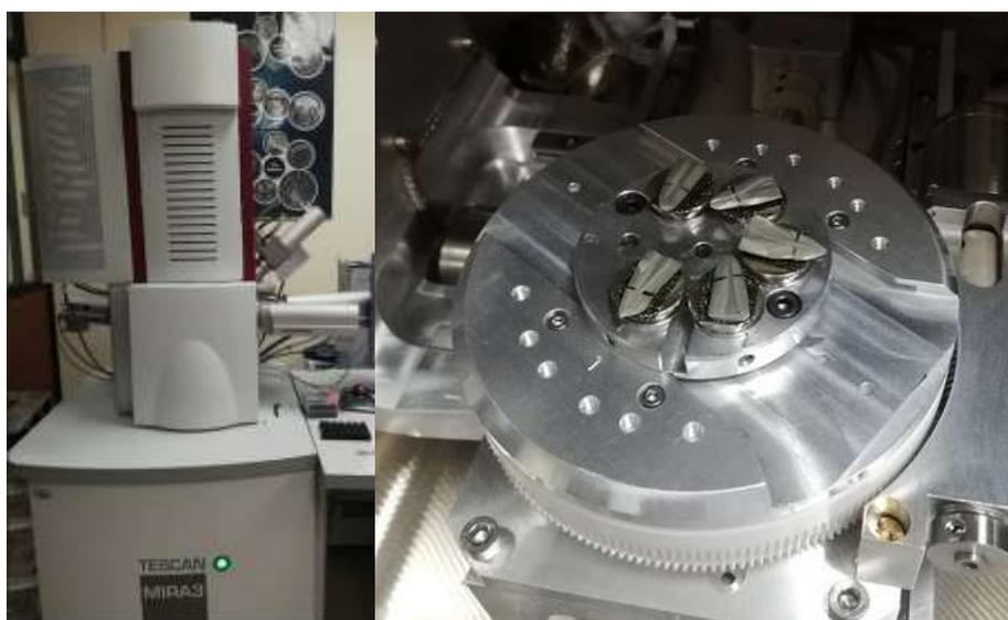
**Figura 17.** Microscopio electrónico de barrido
