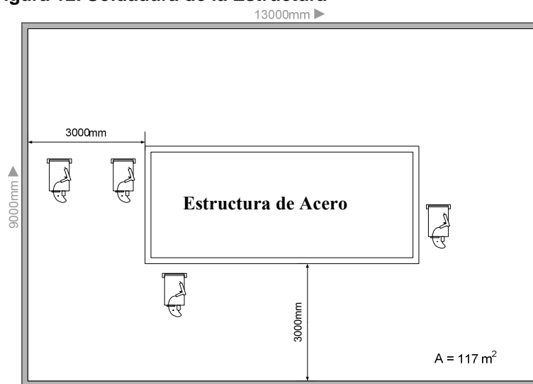
Figura 12. Soldadura de la Estructura
