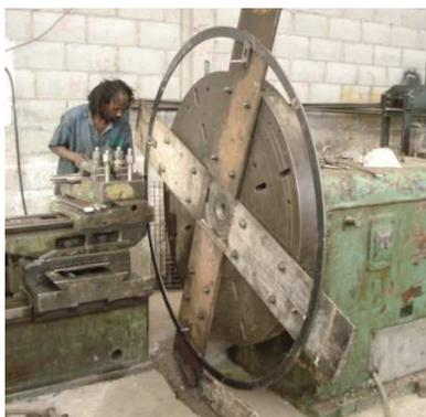
**Ilustración 68. Aro montado en el proceso de centrado**
