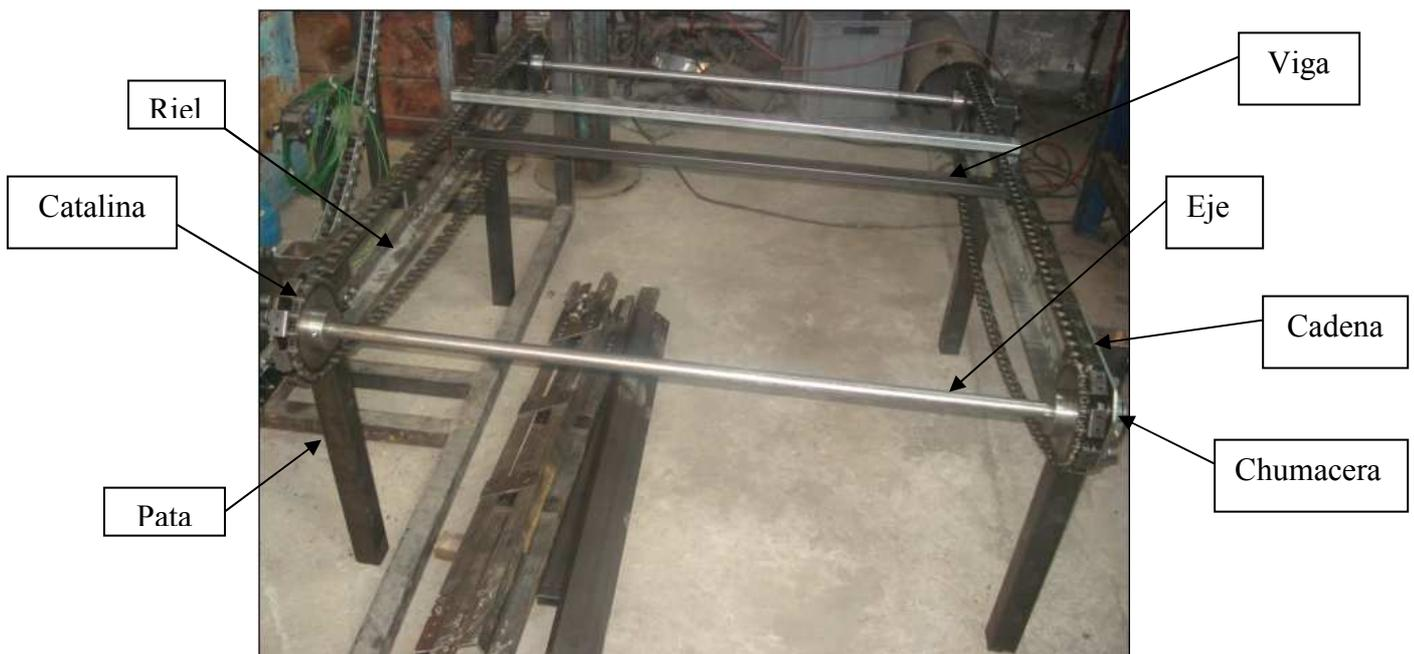
**Ilustración 96. Ensamble de la Banda sin travesaños**
