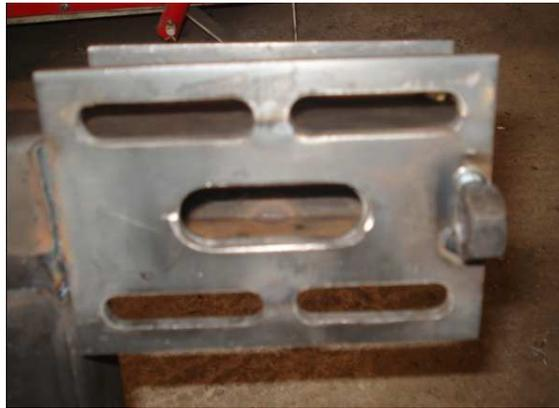
**Ilustración 80. Placa y tubo de sujeción soldados al marco de la estructura.**
