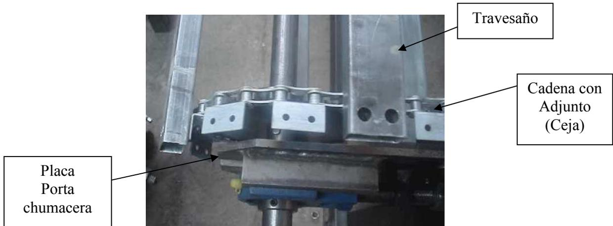
Ilustración 31. Cadena montada en la banda transportadora.
