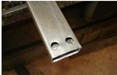
**Ilustración 91. Perforación de 10 mm.**
