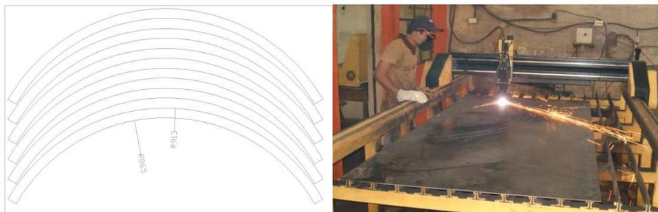
**Ilustración 66. Cortadora de plasma CNC trabajando y Esquema.**
