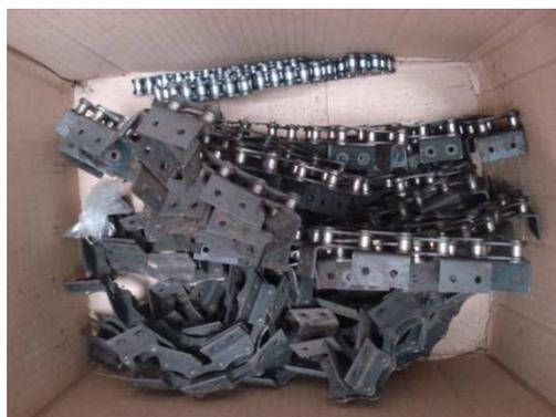
**Ilustración 84. Cadena Después de Desarmar y Limpiar con Diesel.**
