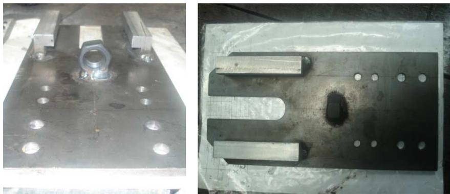
**Ilustración 102. Placa, guía y tuerca soldada.**
