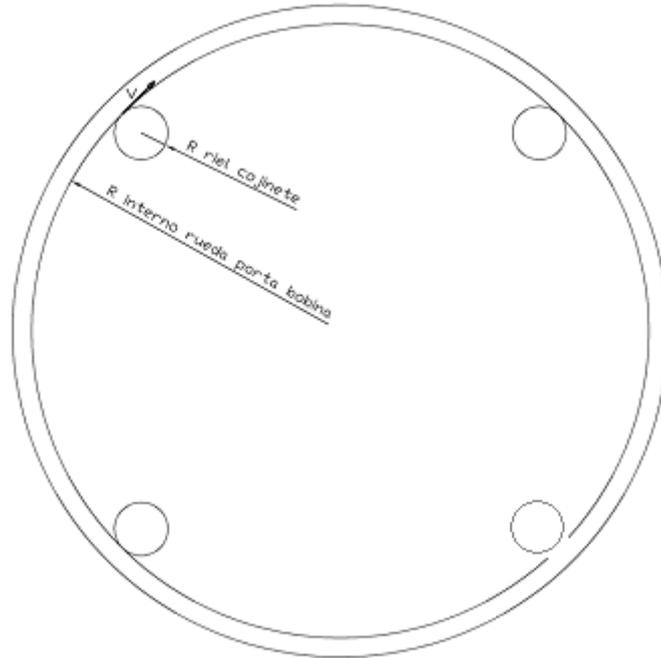
**Ilustración 27. Relación de velocidad entre la rueda porta bobina y los cojinetes.**
