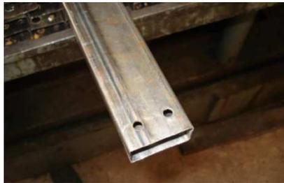
**Ilustración 90. Perforación de 5mm.**
