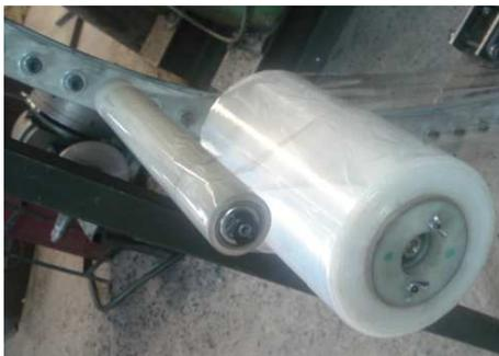
**Ilustración 59. Rodillos Tensor y Porta Bobina montados en la Rueda**
