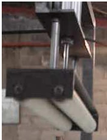
**Ilustración 106. Pistones para Sujetar el Producto.**
