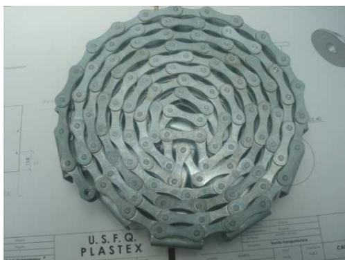
**Ilustración 88. Cadena Galvanizada.**
