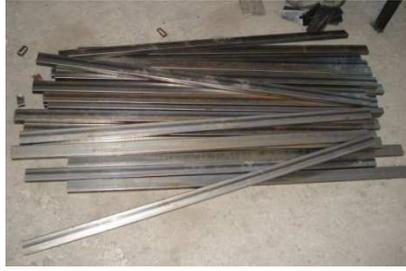
**Ilustración 89. Tubos cortados en longitudes de 1,15m.**
