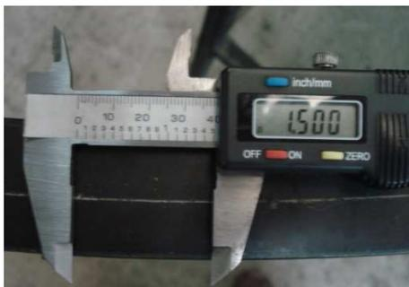
**Ilustración 71. Medida de la Distancia entre perforaciones.**
