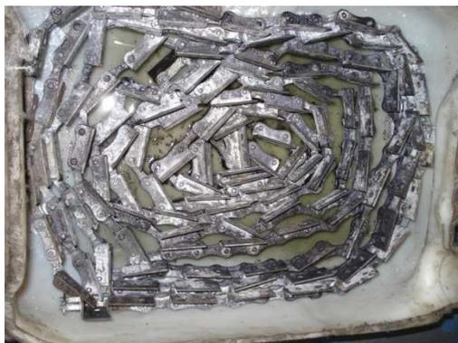
**Ilustración 85. Cadena sumergida en desoxidante.**
