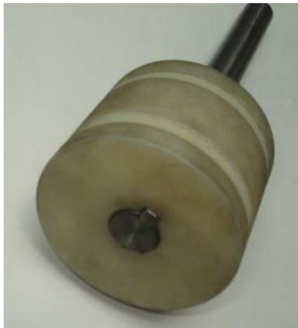
**Ilustración 83. Rodillo de soporte de la rueda en eje de sujeción.**
