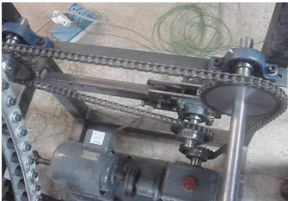
**Ilustración 93. Sistema de transmisión de las bandas transportadoras y motor**
