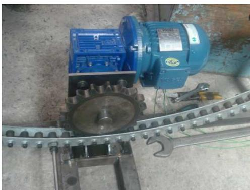
**Ilustración 79. Motor montado en la Estructura.**
