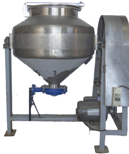
Figura 8- Contiene la mezcladora de polvos de tipo tambor
