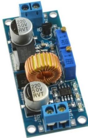
*Figura 88. Reductor de DC a DC*
