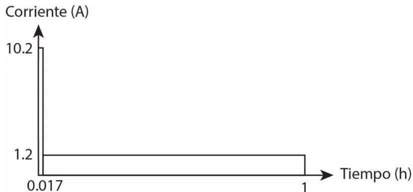
*Figura 78. Consumo de corriente en 1 hora con el sistema de pesaje*
