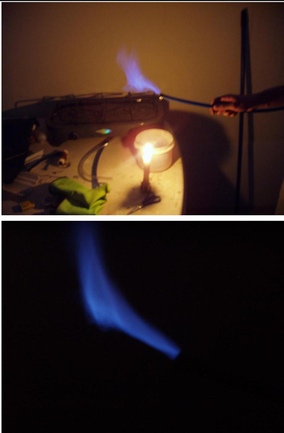
**Figura 4-21:** Prueba cualitativa para la determinación del estado del biogás
