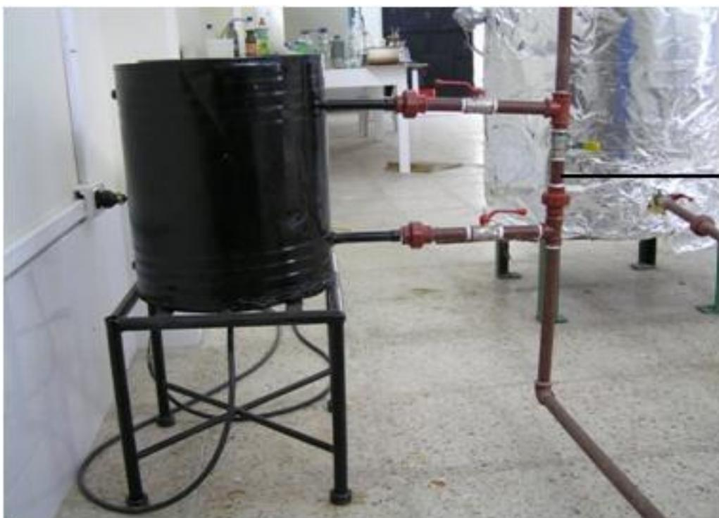
**Figura 3-13:** Intercambiador de calor.
