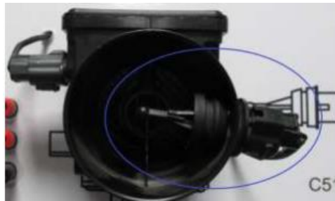
Figura 5 Sensor de temperatura de aire. (Correa González, 2013)
