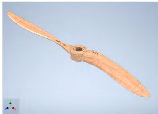
*Figura 37. Hélice 14x8 in de madera utilizada para motor a combustión, vuelo horizontal*
