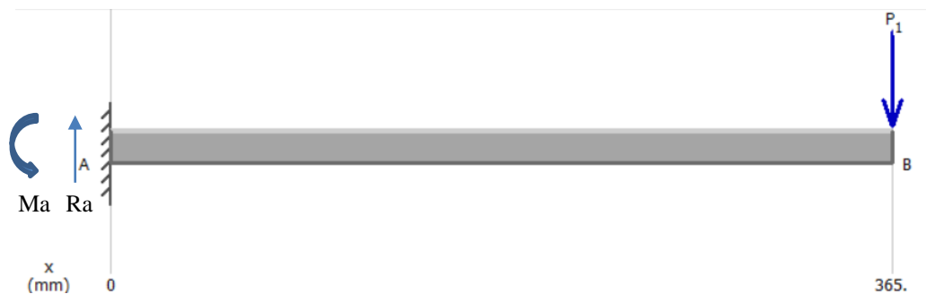
Figura 61. Diagrama de cuerpo libre para el análisis mecánico del soporte
