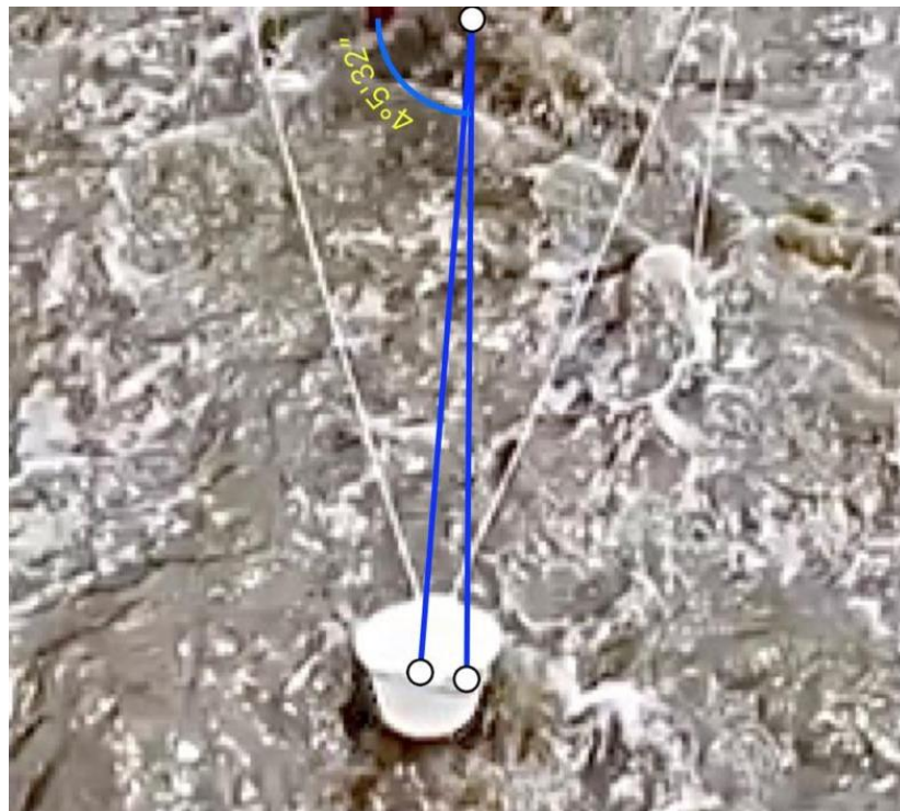
Medición de ángulo para un ancla
