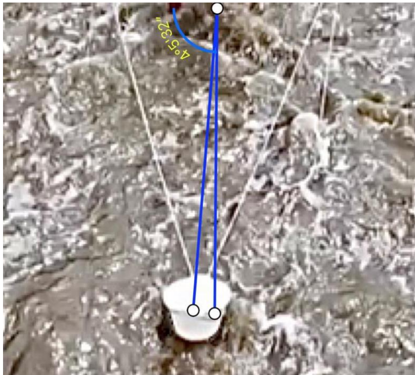
Ángulo de rotación de 4° con dos anclas
