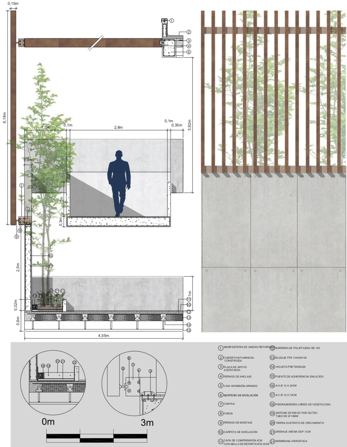
Figura 33. Detalle constructivo 2. Elaboración propia.
