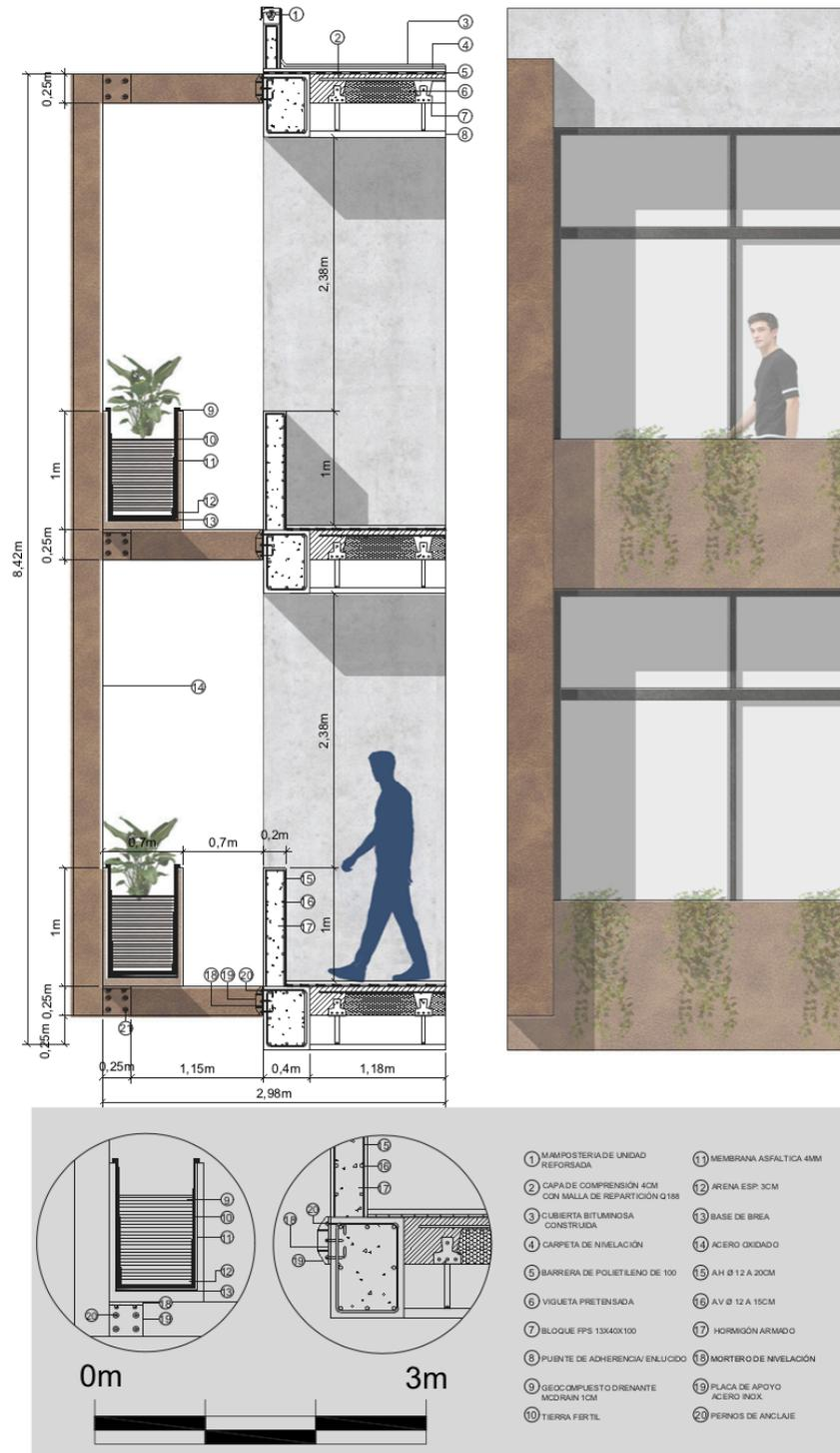
Figura 32. Detalle constructivo Fachada. Elaboración propia.
