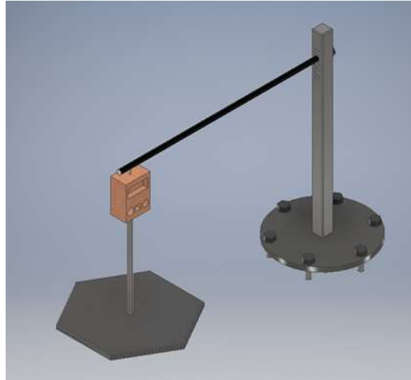
Figura 7. Vista isométrica módulo de pesaje con balanza suspendida
