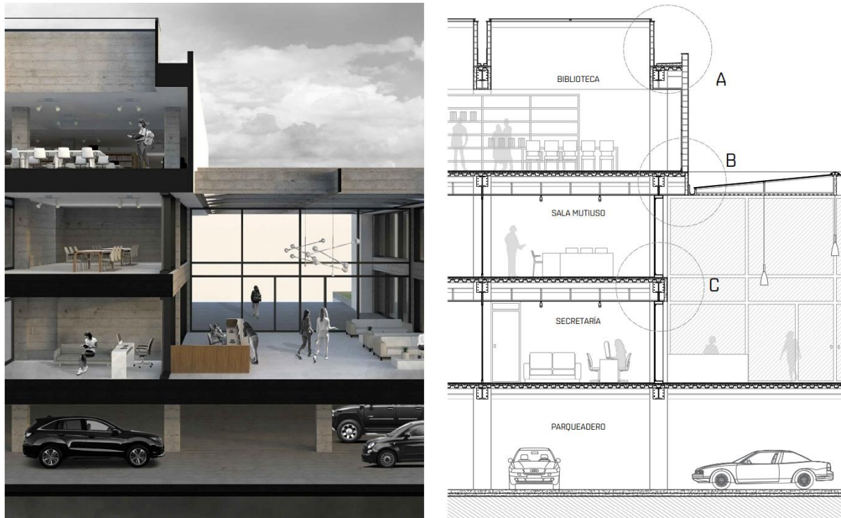
Figura 31. Ampliación / Corte por fachada. Elaboración propia.
