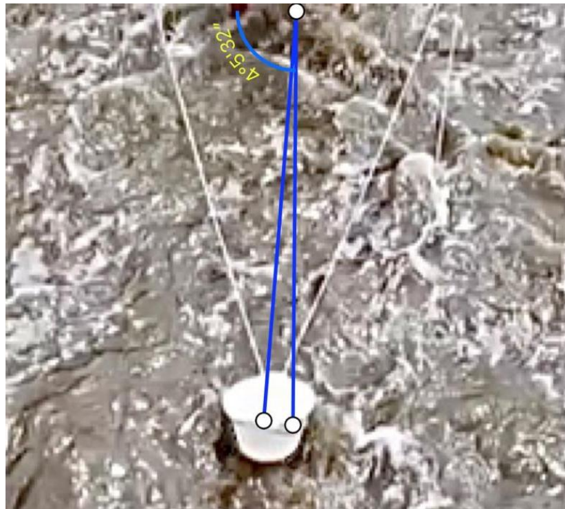
Ángulo de rotación de 4° con dos anclas
