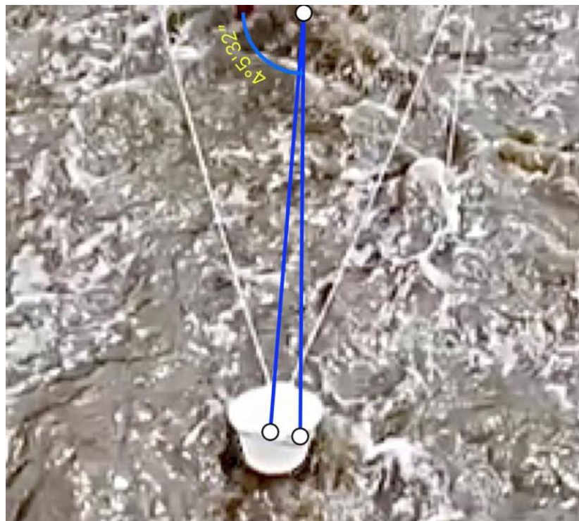
Medición de ángulo para un ancla
