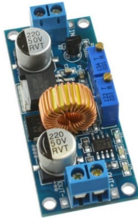
Figura 88. Reductor de DC a DC
