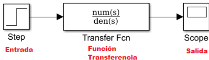
Figura 58. Ejemplo de diagrama de bloques de un sistema dinámico
