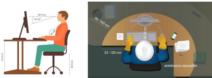
Figura #75. Diagrama de medidas básicas para un puesto de trabajo (Soto, 2017).
