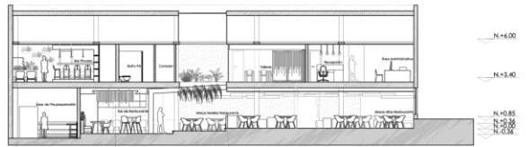
Plantas en espaldar entre los dos booth a todo lo largo del mueble Tubos de metal negro de 30cm de diámetro con luminarias de punto de luz en su extremo interior, cinta LED Inculcación de 10cm de alto a todo lo largo de los contrabios para iluminación indirecta con punto de luz en su extremo interior, cinta LED
