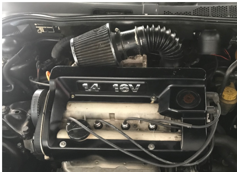
Imagen 2.39 Filtro de alto flujo en una posición incorrecta. Fuente: El autor.
