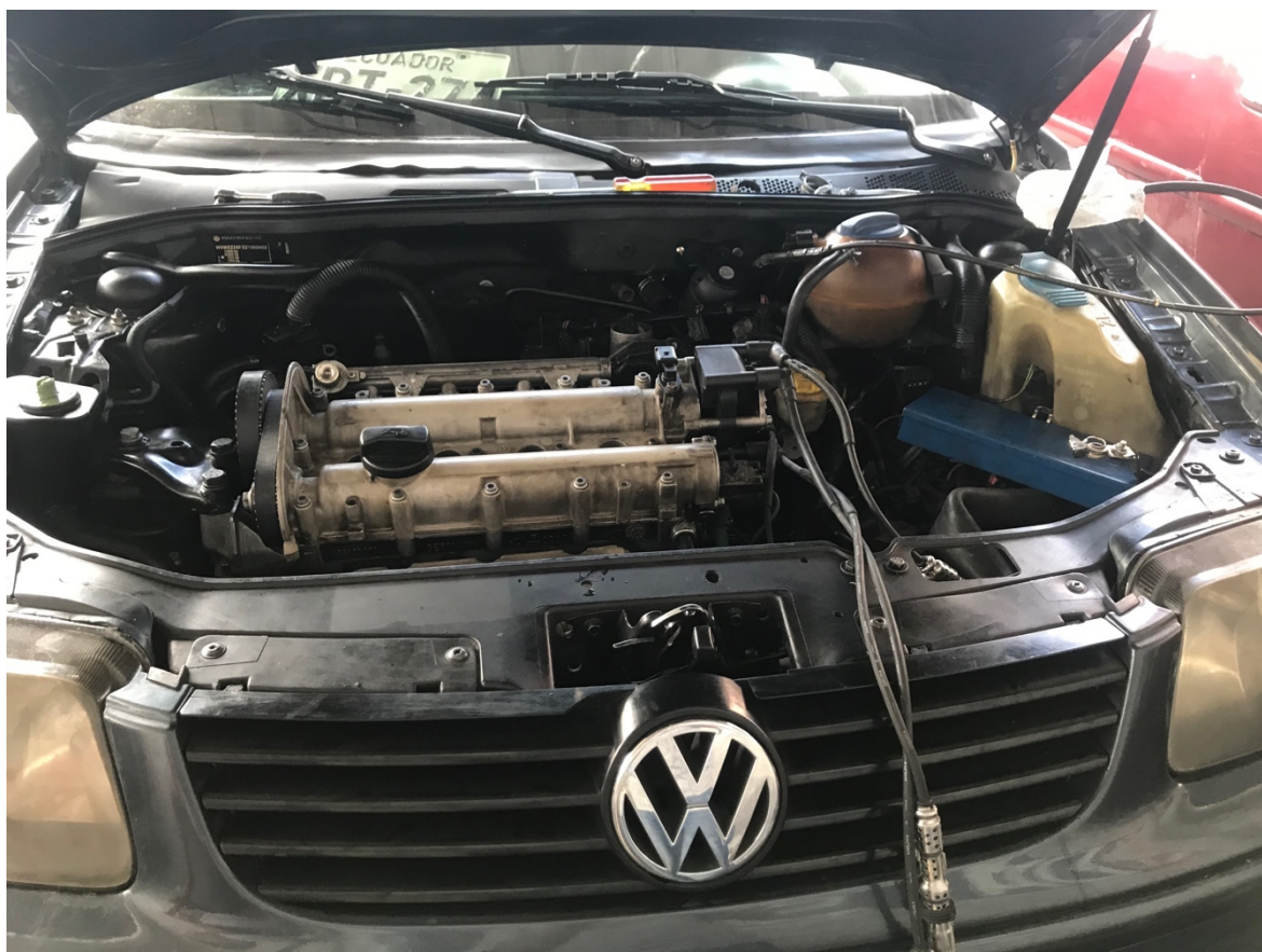
Imagen 2.27 desmontaje de los sistemas conectados al motor. Fuente: El autor.
