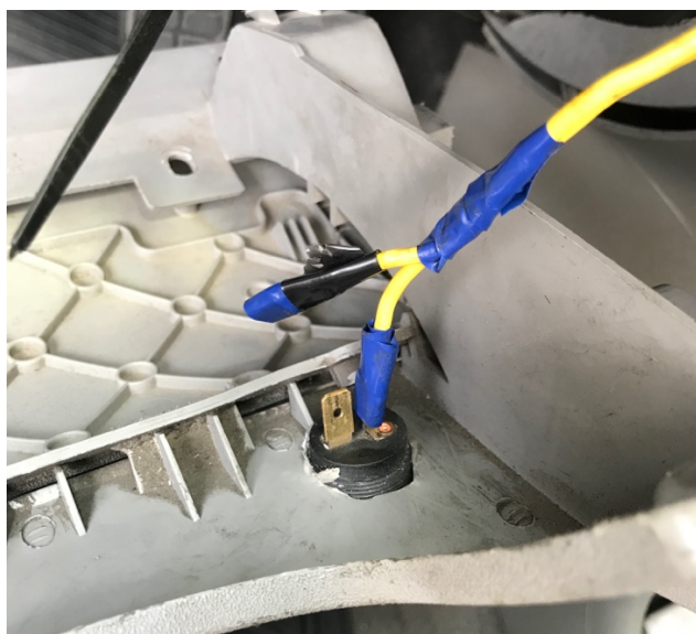
Imagen 2.41 Moldura plástica dañada por una mala practica. Fuente: El autor.
