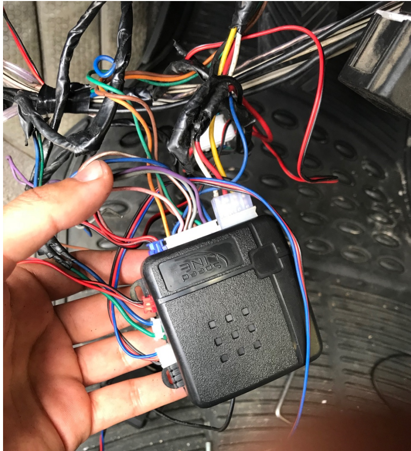
Imagen 2.49 Conexión al bloqueo central del vehículo. Fuente: El autor.
