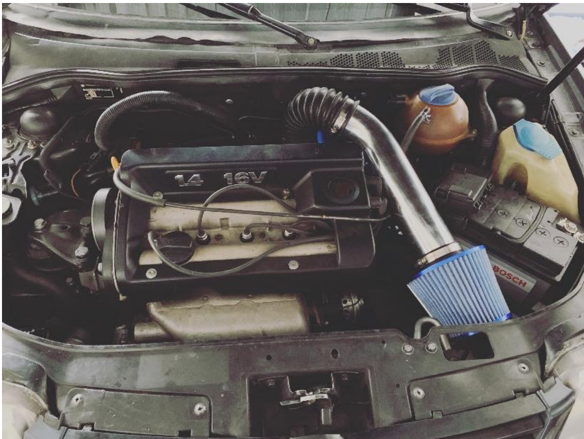
Imagen 2.40 Colocación de intake y filtro nuevo. Fuente: El autor.
