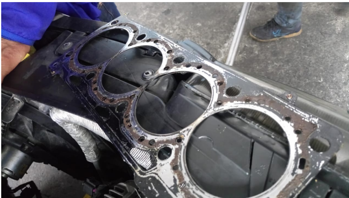
Imagen 2.29 Fisura en el empaque del cabezote. Fuente: El autor.
