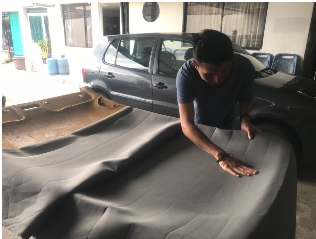
Imagen 2.10 Colocación del textil y amolación del mismo. Fuente: El autor.
