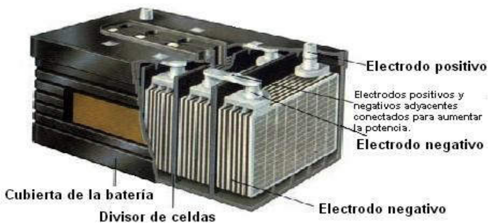
Imagen 1.14 Estructura interna de una batería. Fuente: http://www.sapiensman.com/
