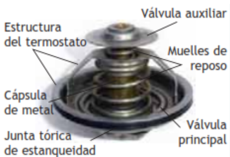
Imagen 1.10 Partes de un termostato. Fuente: https://autoytecnica.com/
