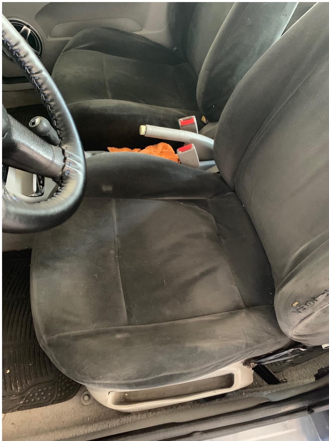
Imagen 2.23 Asientos delanteros deteriorados. Fuente: El autor.
