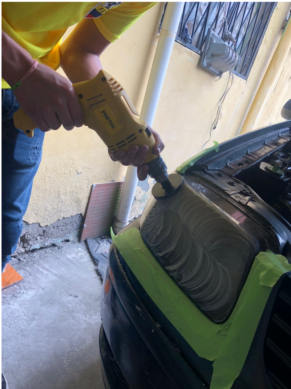
Imagen 2.4 Procedimiento en el pulido de faros. Fuente: El autor.
