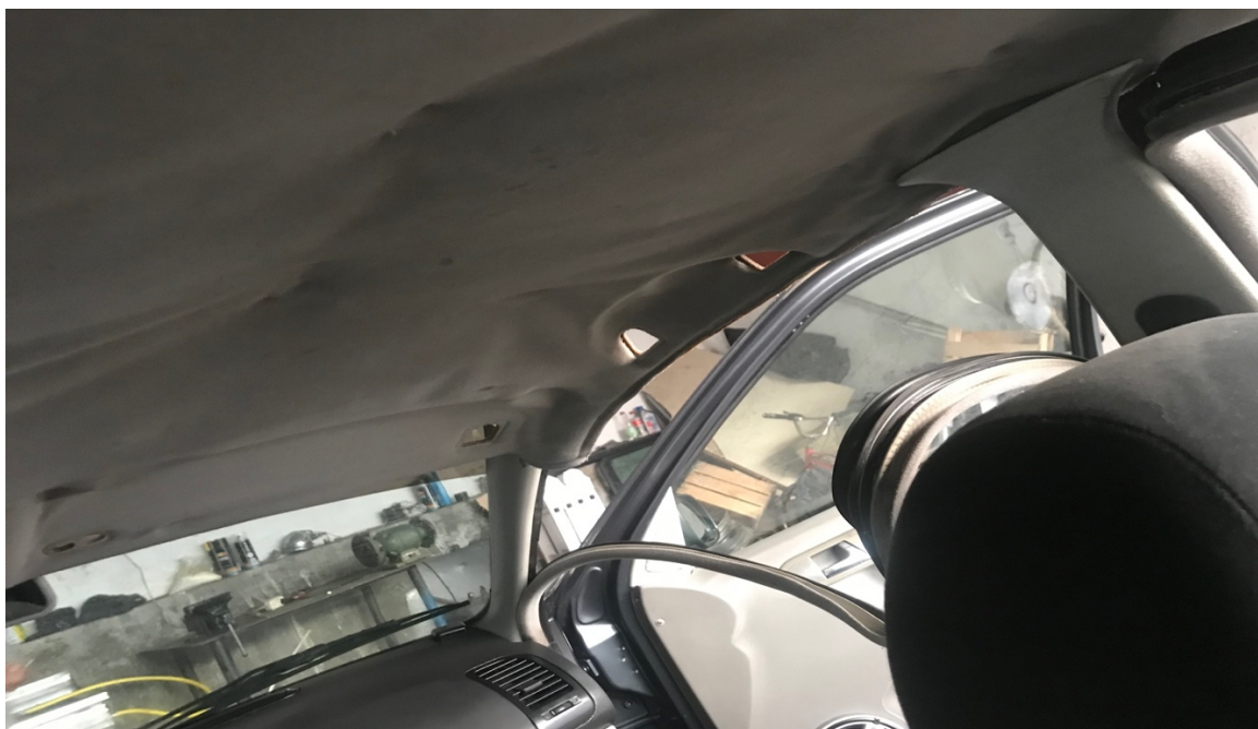
Imagen 2.6 Tapizado del techo colgado por la falta de cuidado. Fuente: El autor.
