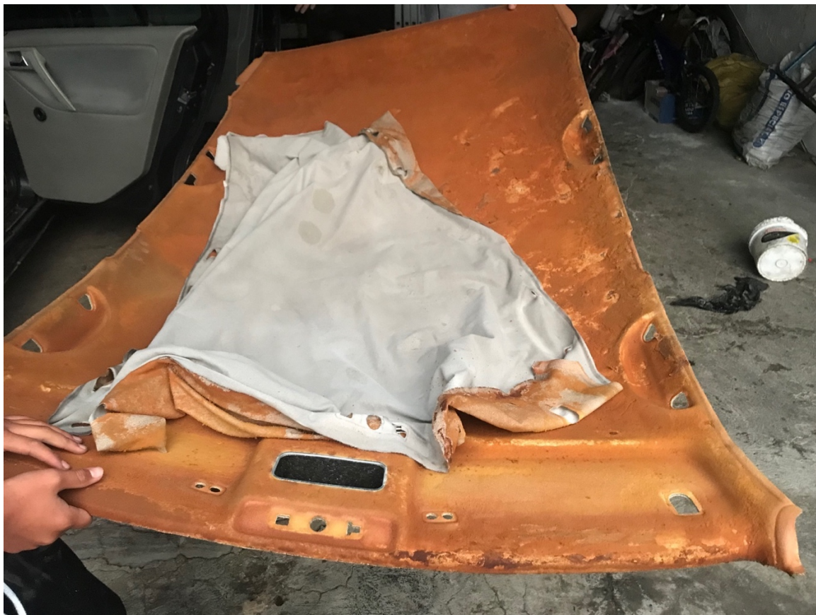
Imagen 2.7 Techo desmontado y retiró del tapizado deteriorado. Fuente: El autor.
