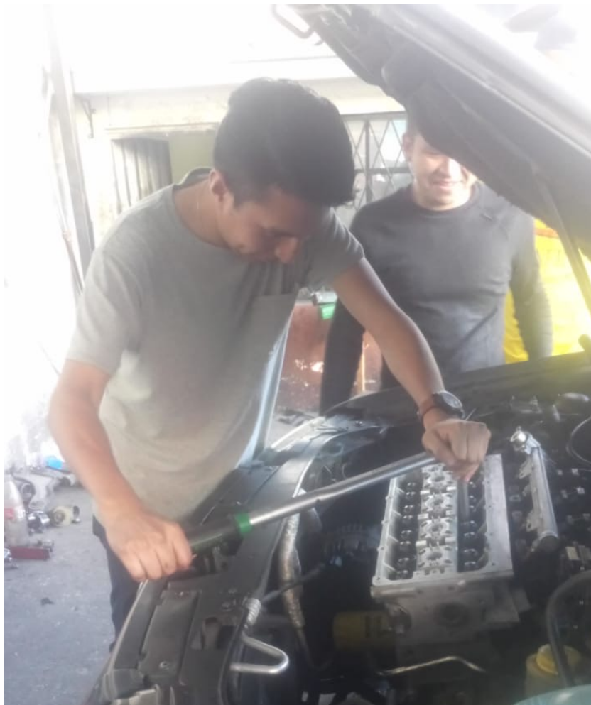
Imagen 2.35 Torque a los pernos del cabezote.
