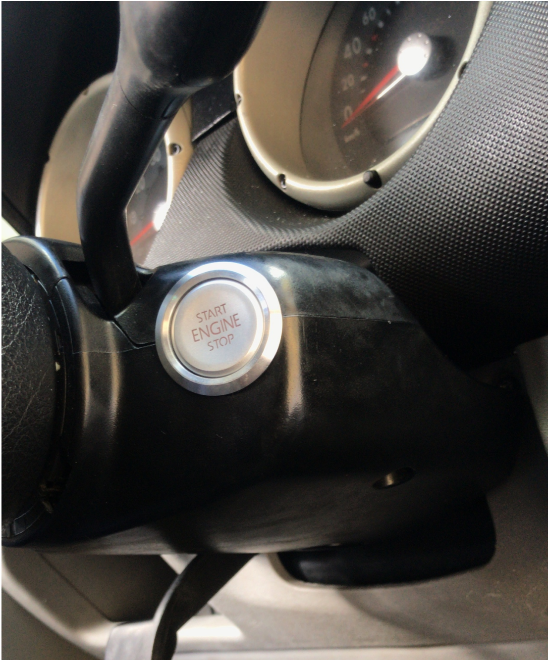
Imagen 2.45 Reemplazo de la llave de encendido por botón. Fuente: El autor.
