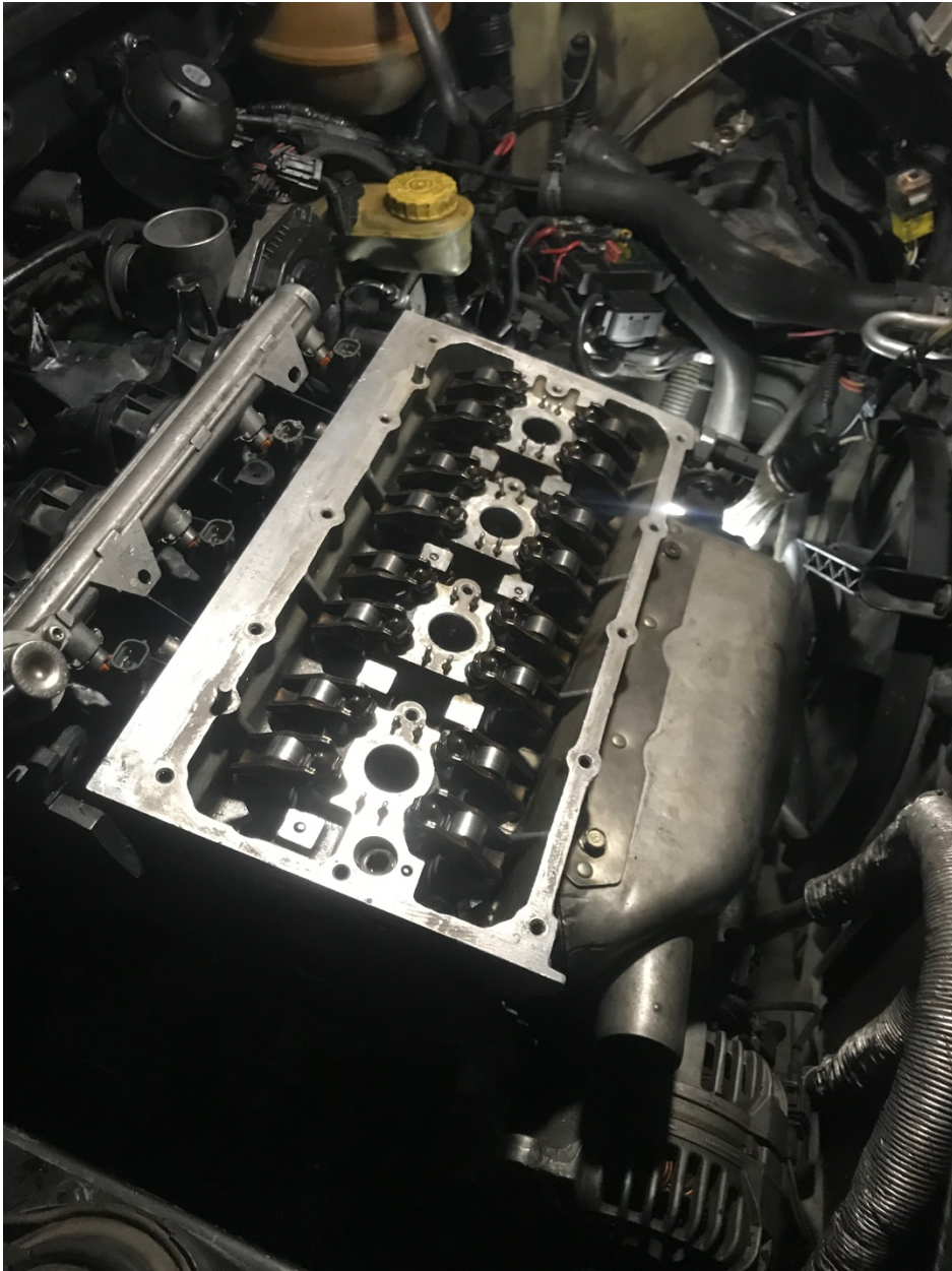
Imagen 2.34 Montaje del cabezote. Fuente: El autor.
