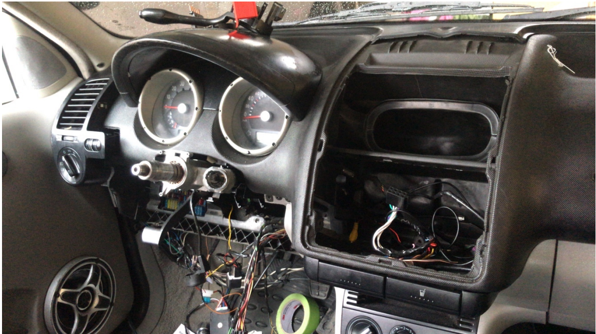
Imagen 2.48 Conexión de cables y módulo Easyguard. Fuente: El autor.
