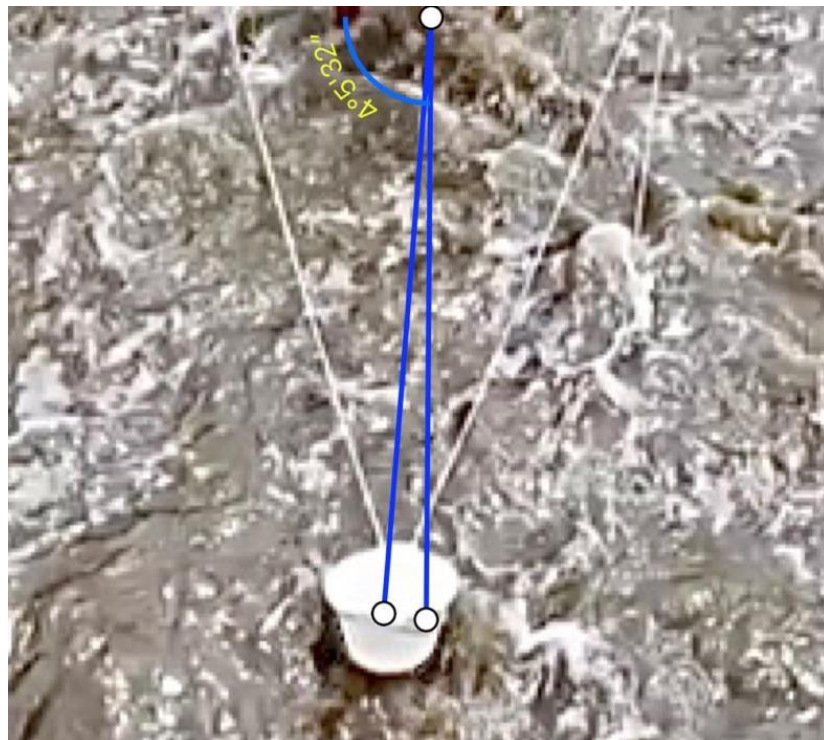
Medición de ángulo para un ancla
