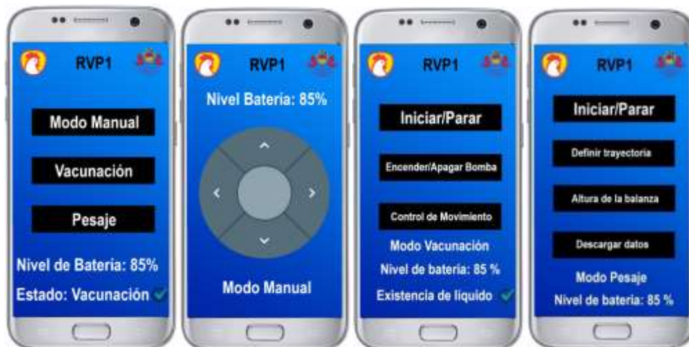
Figura 117. Interfaz de la aplicación para el control del robot multifuncional
