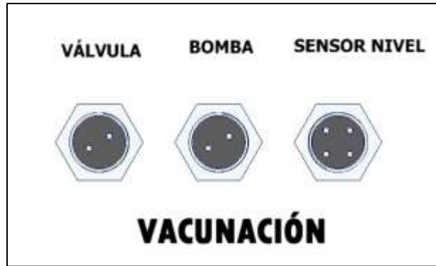
Figura 115. Sockets del módulo de vacunación
