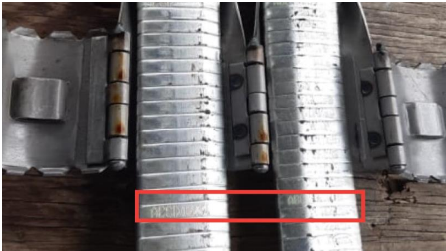
Figura 1. Código para identificación de cables
