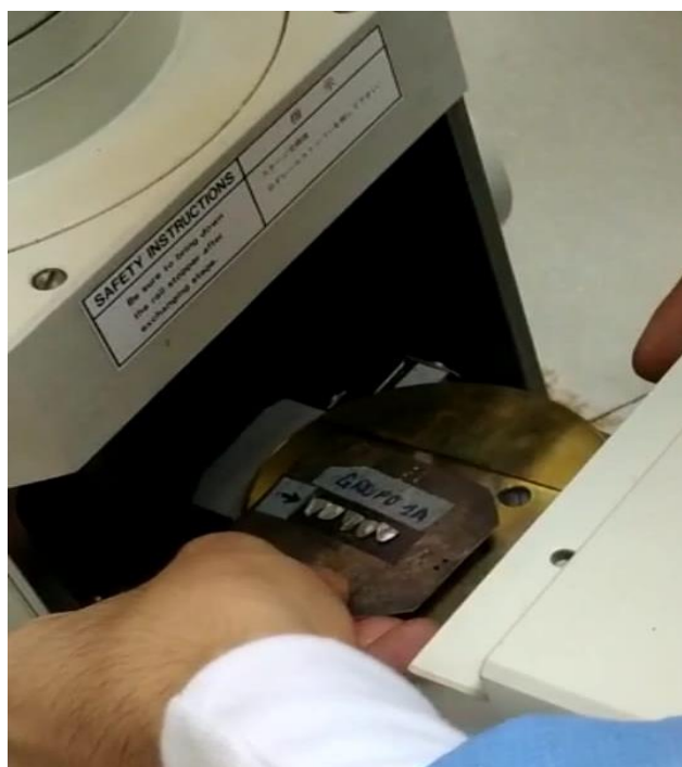
Fig.17 Colocación de las muestras en el Microscopio electrónico de barrido
