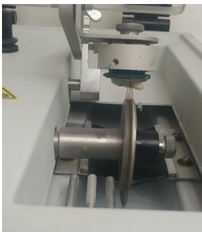
Fig.12 Corte de las muestras
