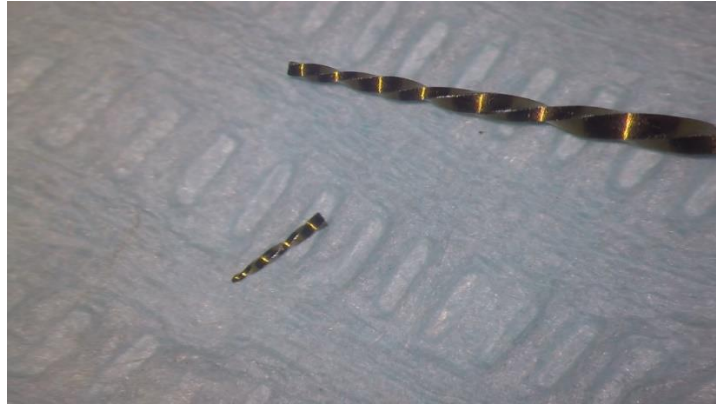
Figura #34. Fractura cíclica de Lima WaveOne Gold Primary. Foto original del autor
