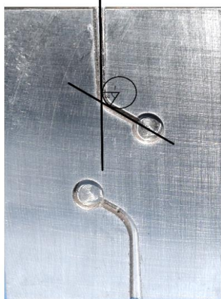
Figura #57. Bloques de acero inoxidable con 2 canales radiculares severos, con ángulos de curvatura de 60^\circ y radios de curva de 2mm o 5mm. Elaborado por autor
