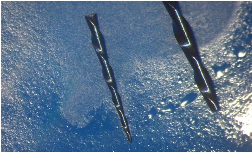
Figura #35. Fractura cíclica de Lima R25 Reciproc Blue. Foto original del autor
