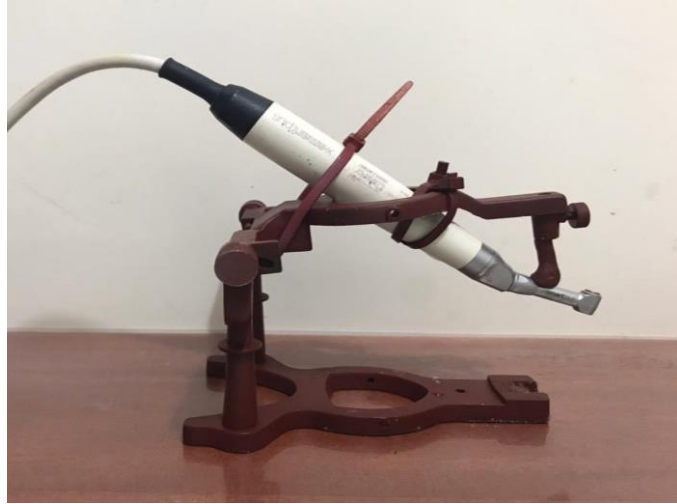
Figura #53: Soporte para pieza de mano endodóntica diseñado sobre un articulador modificado. Foto original del autor
