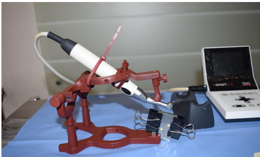
Figura #54. Posicionamiento de pieza de mano sobre aparato modificado y muflas de acero fijado y sellado con placa de vidrio para instrumentación de estudio. Elaborado por autor
