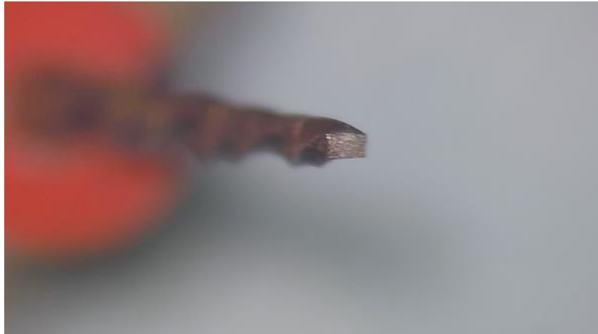
Figura #73: Imagen a 20x de aumento de Fractura por fatiga cíclica de Lima Primary WaveOne Gold # 8 del Grupo N°2 del estudio. Elaborado por el autor
