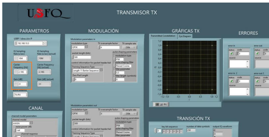
Figura 66: Parámetros modificados en el VI de transmisión de señal
