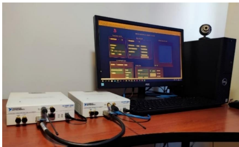
Figura 26: Conexión física de los dispositivos TX-RX con el PC
