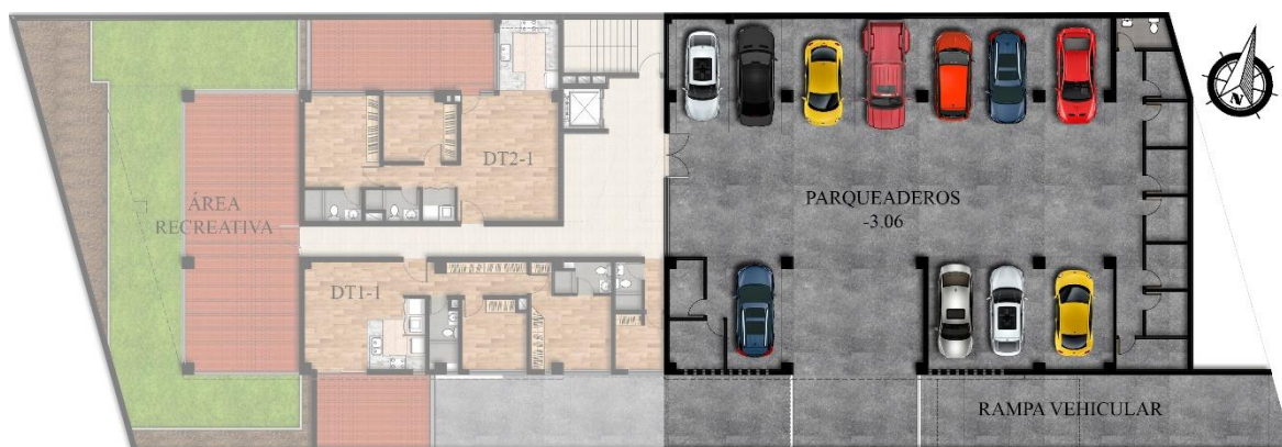
Ilustración 97 Planta de Subsuelo 1 Estacionamiento (Nivel -3.06)
