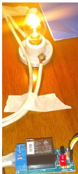
*Figura 15. Foco encendido a 110V por medio del relé al momento de detectar una persona con confianza igual o mayor al 60%.*
