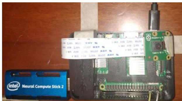
Figura 1. Raspberry PI, con el Neural Compute Stick y la camera module V2.
