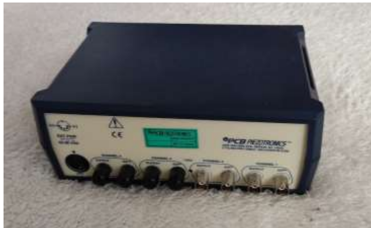
Figura No. 6: Acondicionador de señal.
