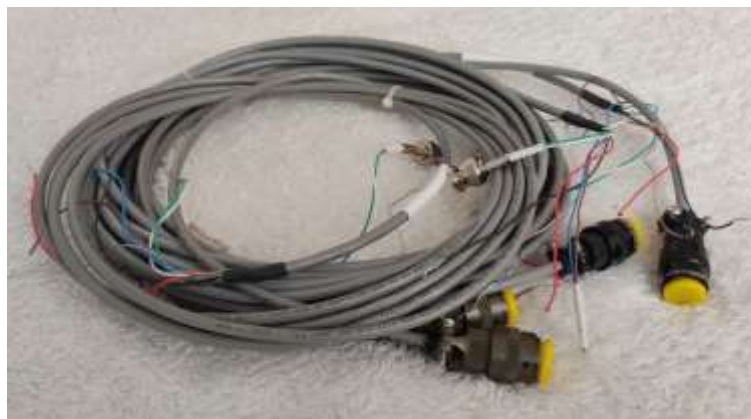
Figura No. 4: Cables para conectar a sensor de presión.
