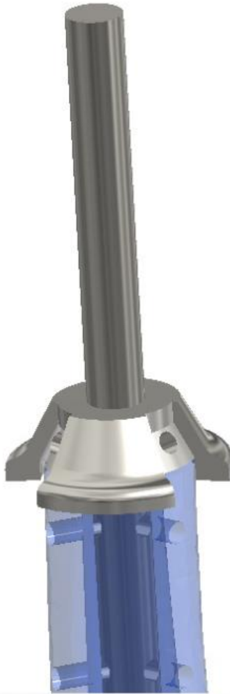
Fig 16. Colocación del flange.
