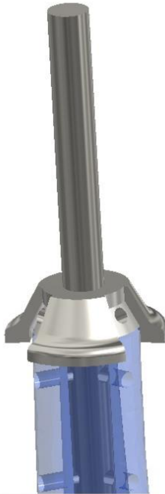
Fig 16. Colocación del flange.
