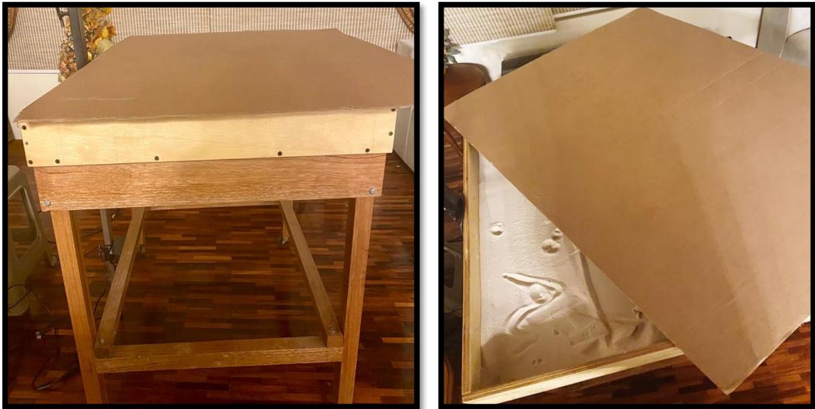
Figura 3: Caja de madera con cartón prensado para calibración.
