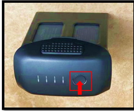
Figura 37: Encendido de batería dron.
