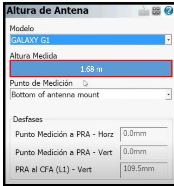
Figura 63: Establecer el mismo valor anterior de la altura de la antena al suelo.
