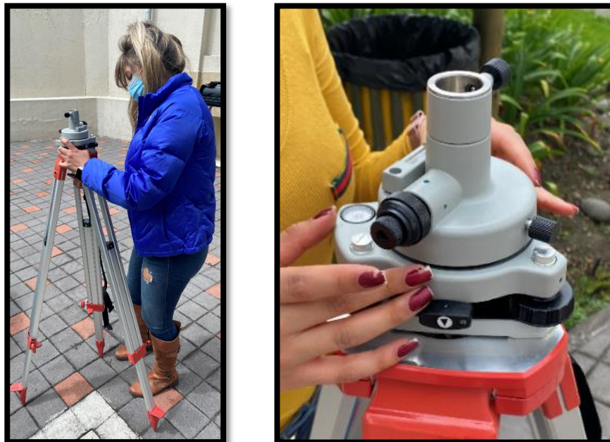
Figura 43: Plantación de trípode y nivelación de equipo RTK.
