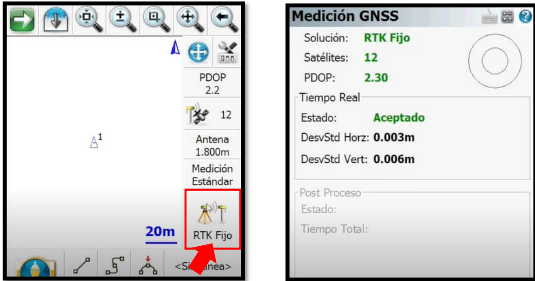
Figura 64: Seleccionar la opción RTK Fijo y tomar los puntos de control del terreno.
