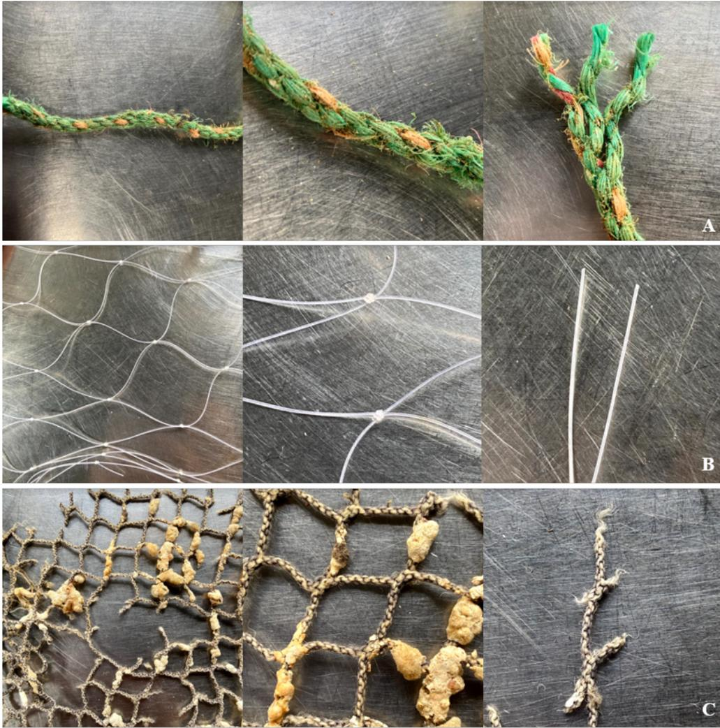
*Figura 10. Principales materiales de las redes recolectadas. (A) Polietileno (B) Poliamida (C) Polipropileno.*
