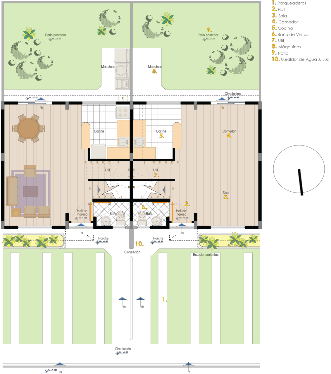
PRIMERA PLANTA BAJA - CASA TIPO STANDARD Escala 1:50
