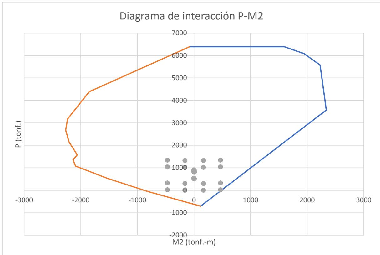
**Figura 73: Diagrama de interacción de muro diseñado, P-M2 (sismo en dirección X)**
