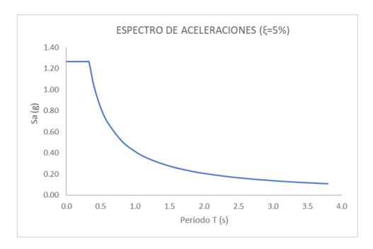
Figura 13 Demanda Sísmica - Espectro de Diseño
