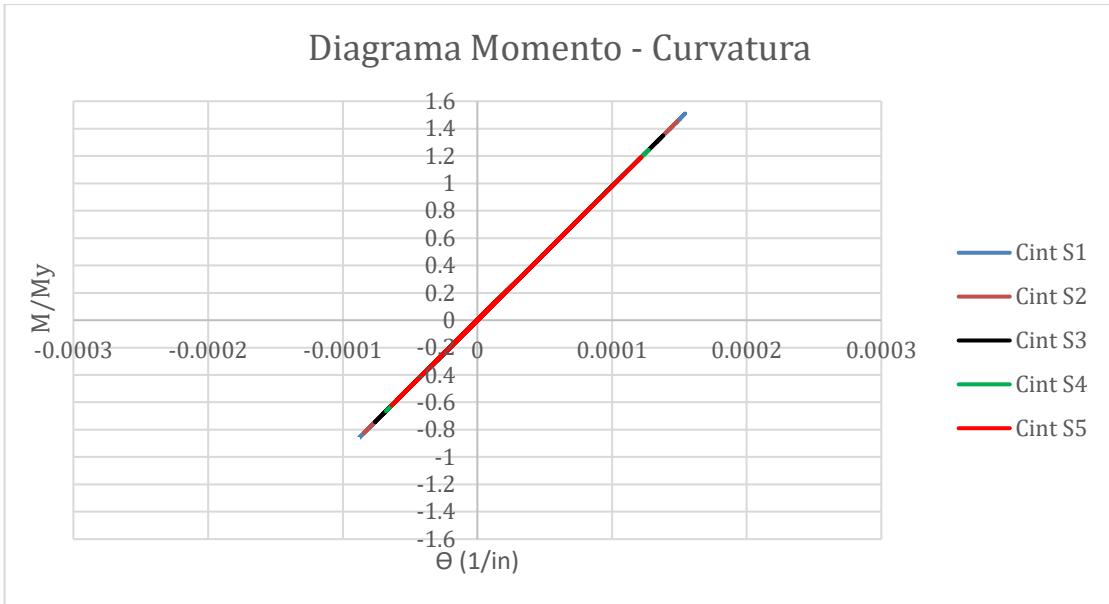
*Nota.* El diagrama pertenece a la columna interior de la estructura
