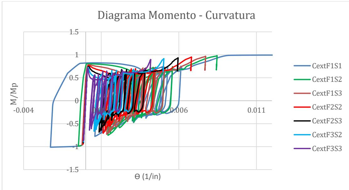
*Nota.* El diagrama pertenece a la columna exterior de la estructura
