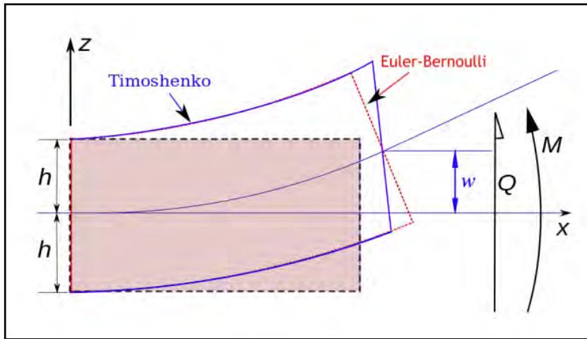
*Nota.*  $M$  es el momento flector,  $Q$  es la fuerza cortante,  $w$  el desplazamiento del eje y  $2h$  la altura de la viga. Tomado de (Nguyen, 2017).
