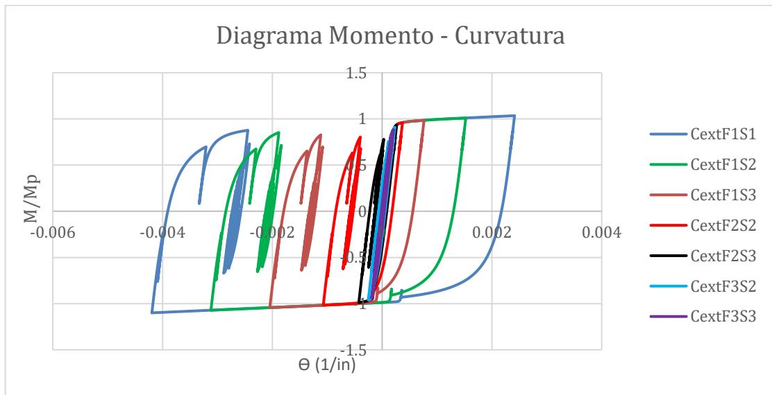
*Nota.* El diagrama pertenece a la columna exterior de la estructura
