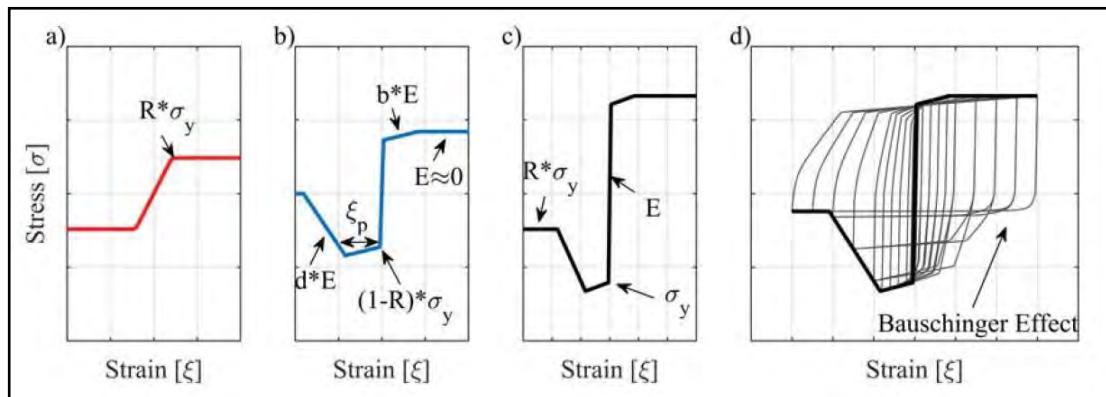
*Nota.* a) steel02, b) hysteretic, c) envolvente monotónica, d) envolvente cíclica.
