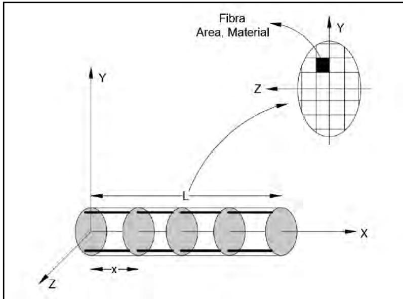
*Nota.* En la imagen se logra apreciar una viga con 5 puntos de integración, y la discretización de una sección circular, a manera de ejemplo. Tomado de (Filippou, Spacone, & Taucer, 1996).
