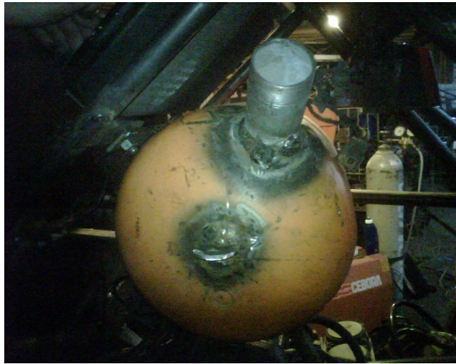
Fig. 2.7.1. Tanque de gasolina con la tubería de llenado 145 .
