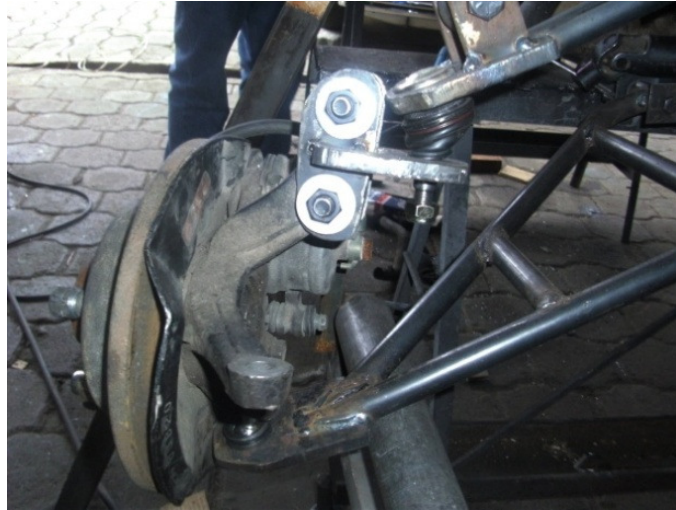
Fig.2.3.4. Sistema de sujeción del portamasas delantero a la mesa superior. 109
