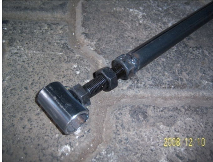
Fig.2.3.2. Extremo de la mesa que permite alineación 107 .
