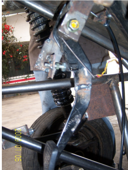
Fig. 2.6.8. Vista lateral de pedal de embrague y regulación altura del pedal 144 .
