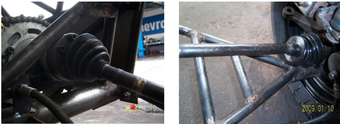
Fig. 2.2.4. Conexión de los homocinéticos para transmisión del torque 104 .
