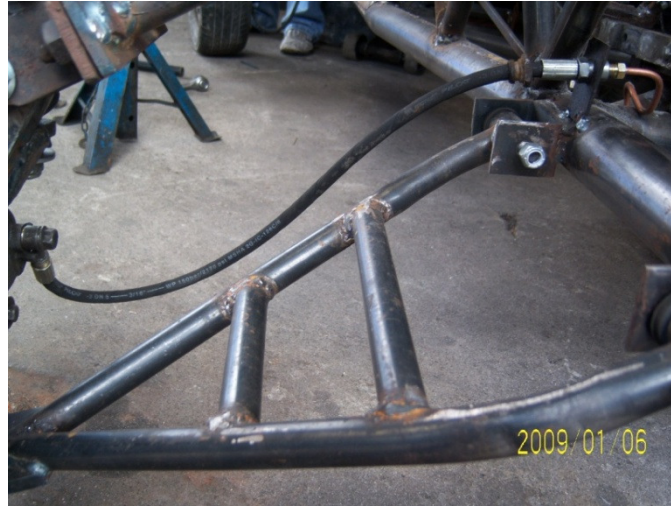
Fig. 2.5.3. Conexión de la cañería con la manguera de freno 135 .
