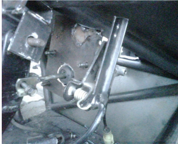
Fig. 2.6.2. Base de acelerador y agujeros para el paso del cable 138 .
