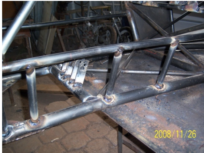
Fig. 2. 1. 12. Soporte para la parte del chasis de la motocicleta 95
