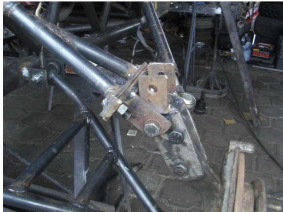
Fig.2.3.16. Mecanismo de alineación del toe posterior (vista posterior) 121 .
