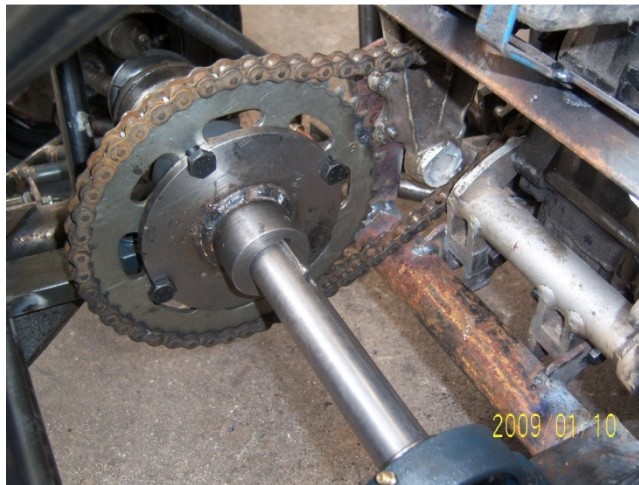
Fig. 2.2.3. Piñón de la caja de cambios conectada a la catalina mediante cadena 103
