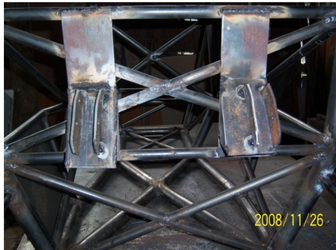
Fig. 2. 1. 13. Soportes para el chasis cortado de la motocicleta 96
