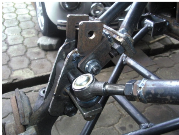
Fig.2.3.20. Platinas que conforman la base posterior para amortiguador 125 .
