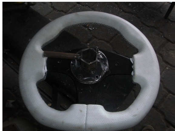
Fig. 2.4.2. Volante con conexión hembra 129 .
