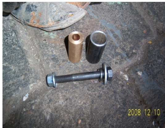
Fig.2.3.14. Bocín de bronce del mecanismo posterior de anclaje del portamasas 119 .
