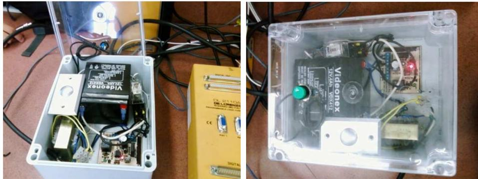
Fig.F.6.Fotografías del sensor y los elementos para el funcionamiento del paracaídas
