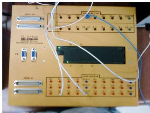
Fig.F.7.Fotografía del PLC con la conexión de su entrada I0.1 y de la salida Q0.0 implementadas
