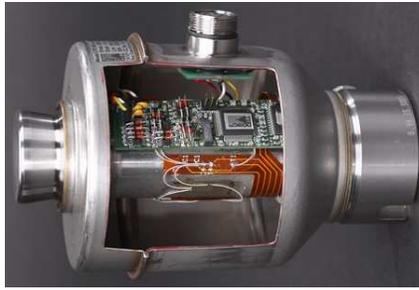
Fig.G.7.Corte transversal de una celda de carga digital[27]
