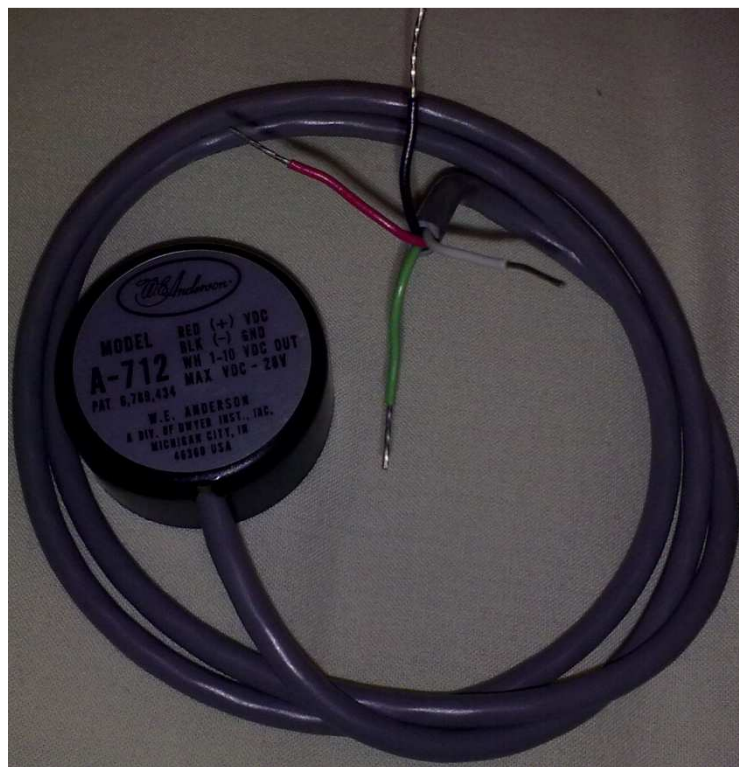
Figura 6.1 Sensor de flujo W.E Andersson A-712 y cables de conexión
